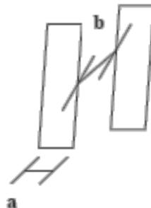
a: espesor de las barras en la dirección del flujo      10 mm      (frontal)
