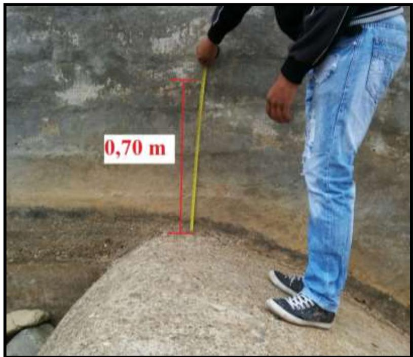
Mediante el siguiente cuadro comparativo se puede verificar que el tirante generado por el caudal de la avenida de proyecto tiene casi la misma magnitud que la altura medida en las marcas dejadas por el flujo en la sección de control.
