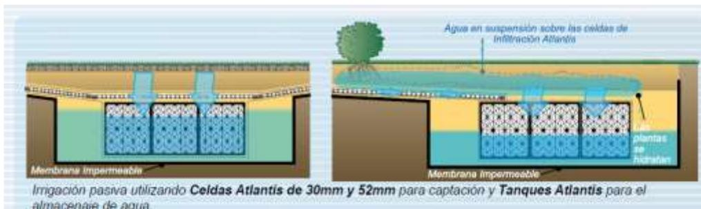
Depósitos permeables o de percolación: Acumulan temporalmente el agua permitiendo su progresiva infiltración al terreno para la recarga de acuíferos.
