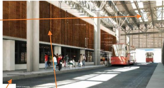
El envolvente interior considera pavimento de baldosa micro vibrada, para pisos superiores se especifica pavimento vinílico, las tabiquerías son de yeso cartón con aislaciones específicas según requerimientos acústicos v térmicos.
