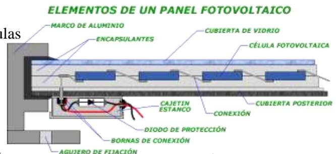
Ilustración 171: Elementos de un Panel
