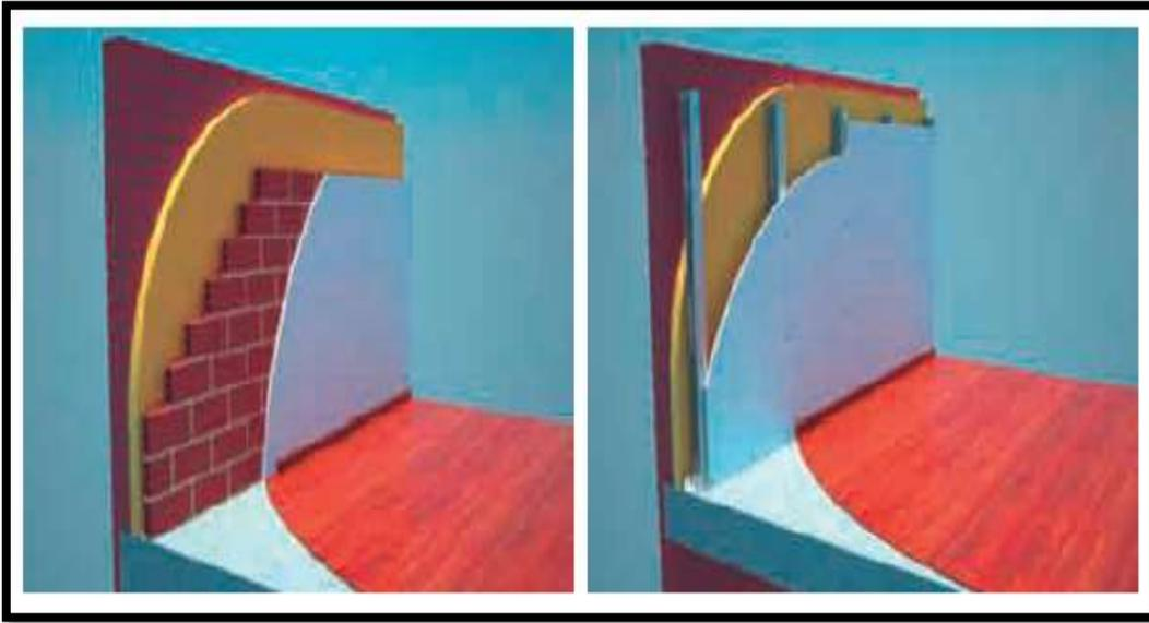
**Figura 42 Fachada con aislamiento interior.**
