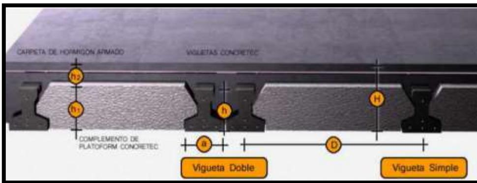
**Figura 32** Imagen ilustrativa de losas y viguetas con complementos.
