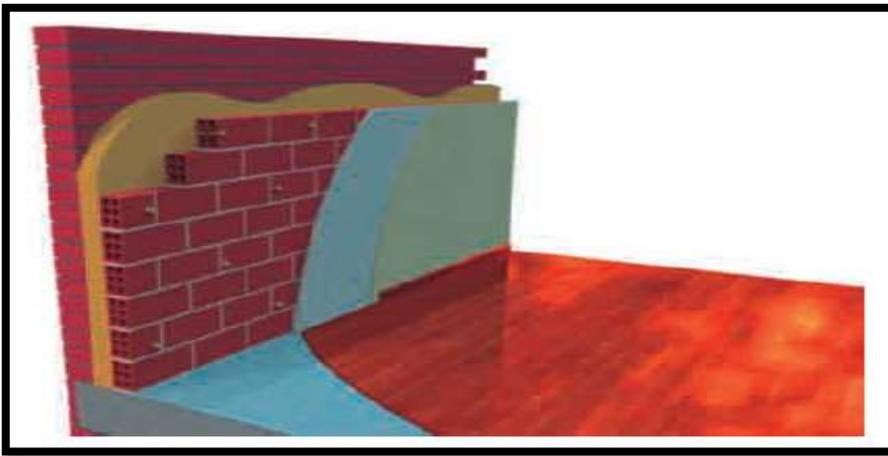
**Figura 45 Fachada con cámara para inyección.**
