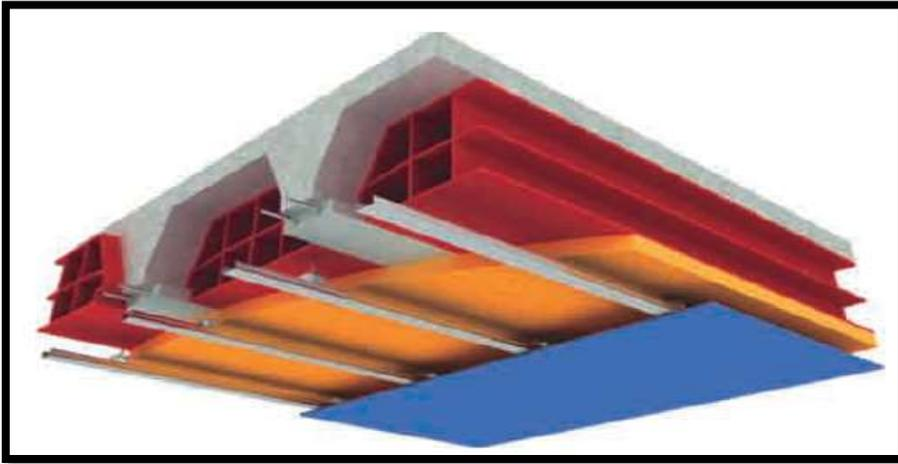
**Figura 47 Aislamiento por debajo de losa.**
