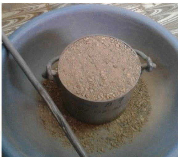
Fotografía 20: Nivelación de la superficie con una regla enrasadora (Agregado fino)
