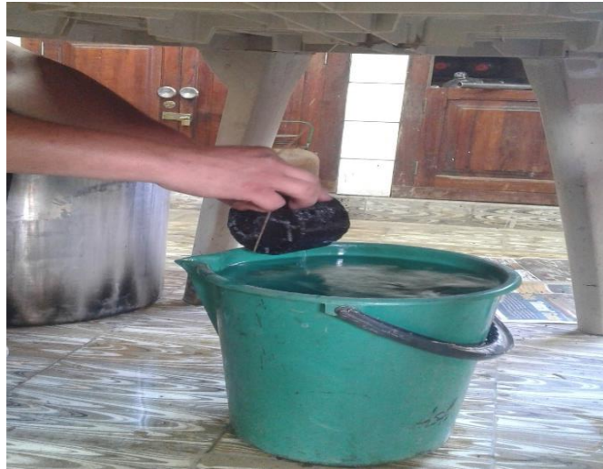
Fotografía 74: Peso de las briquetas - peso sumergido en agua
