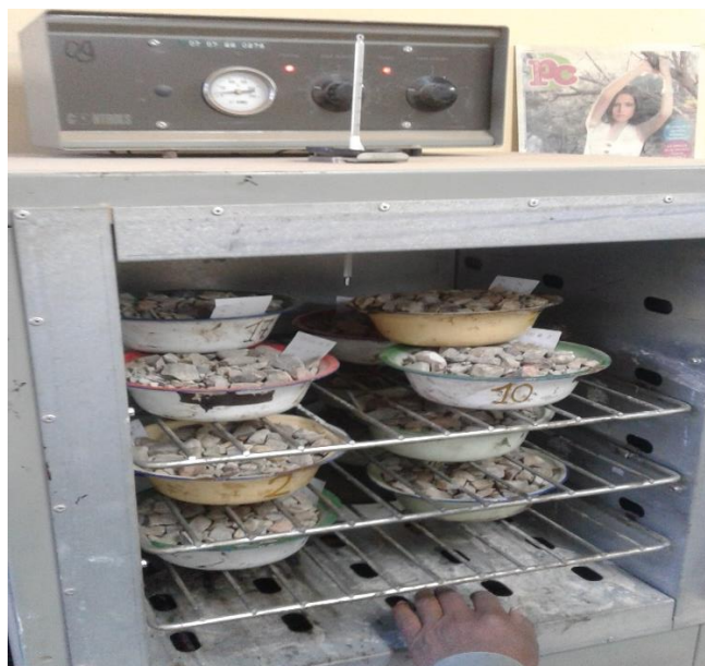
Fotografía 61: Muestras preparadas para dosificación Marshall llevadas al horno
