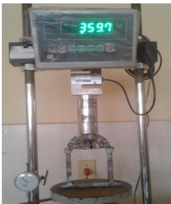
Fotografía 80: Muestra de forma semicircular, ensayada a fractura
