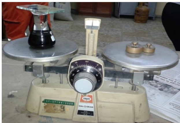
Fotografía 53: Registro de peso picnómetro + asfalto + agua
