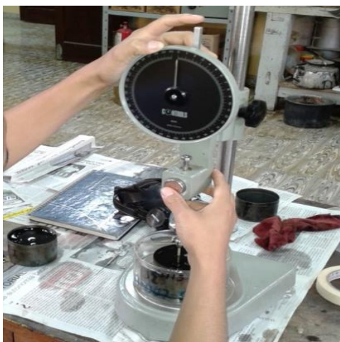
Fotografía 51: Lectura de penetración 25°C, 5 segundos y con un peso de 100 grs.
