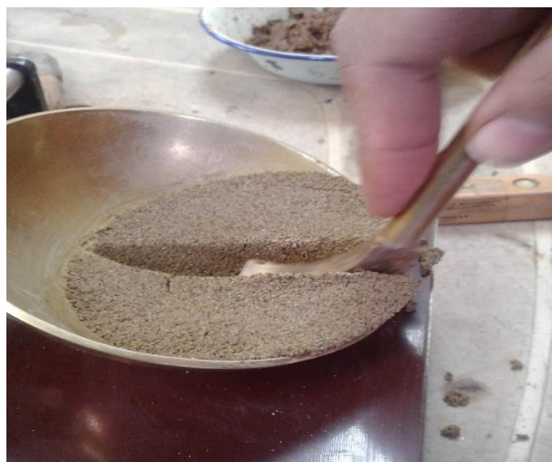
Fotografía 35: División de la pasta de suelo con el acanalador
