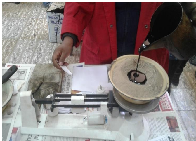
Fotografía 62: Incorporación de cemento asfáltico para dosificación Marshall
