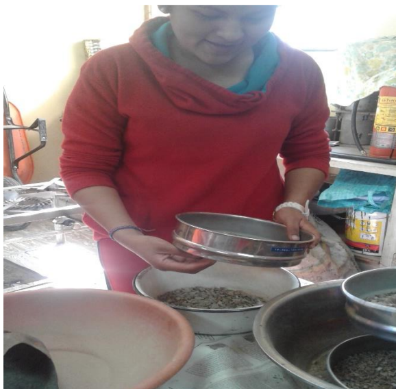
Fotografía 7: Tamizado de material grueso (gravilla) para ensayo de granulometría
