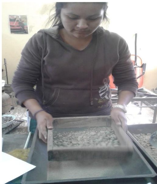
Fotografía 14: Corte del material en el tamiz N° 4 (4,75 mm)
