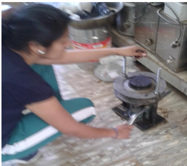
Fotografía 70: Extracción de briquetas
