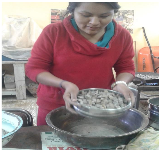
Fotografía 6: Tamizado de material grueso para ensayo de granulometría
