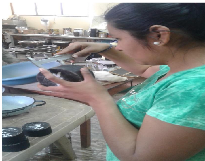
Fotografía 72: Medición de la altura de las briquetas
