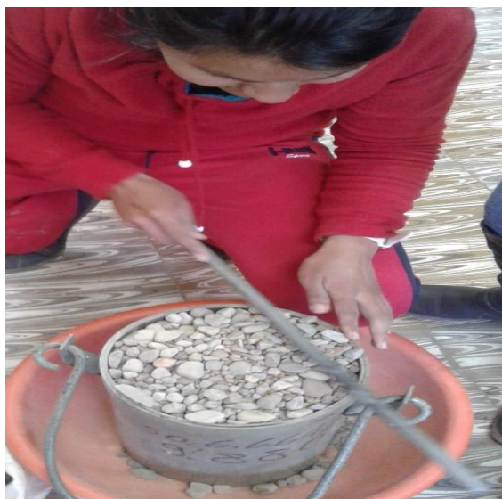
Fotografía 19: Nivelación de la superficie del agregado grueso con una regla enrasadora
