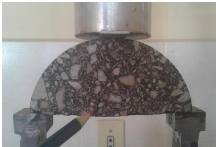
Fotografía 79: Probeta Marshall de forma semicircular, ensayada a fractura
