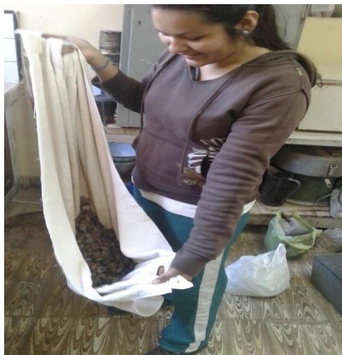
Fotografía 11: Secado de muestra agregado grueso para ensayo de peso específico
