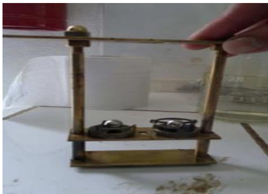
Fotografía 55: Colocación de esferas en el anillo
