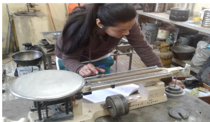
Fotografía 12: Calibración de balanza para pesado de agregado grueso
