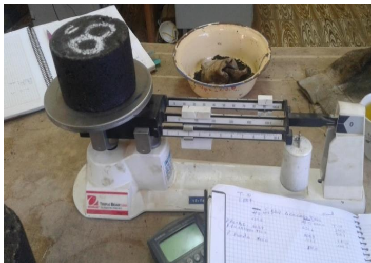
Fotografía 73: Peso de las briquetas - peso seco
