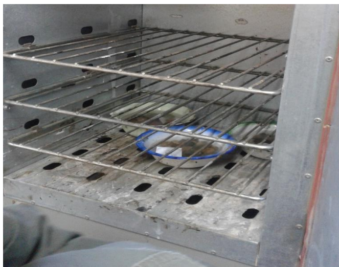
Fotografía 32: Material de ensayo de sulfato de sodio en el horno
