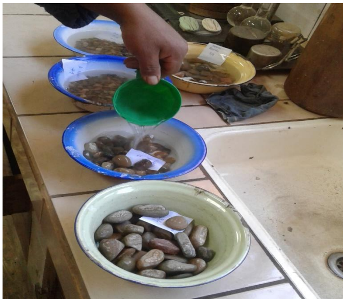
Fotografía 31: Material preparado con sulfato de sodio
