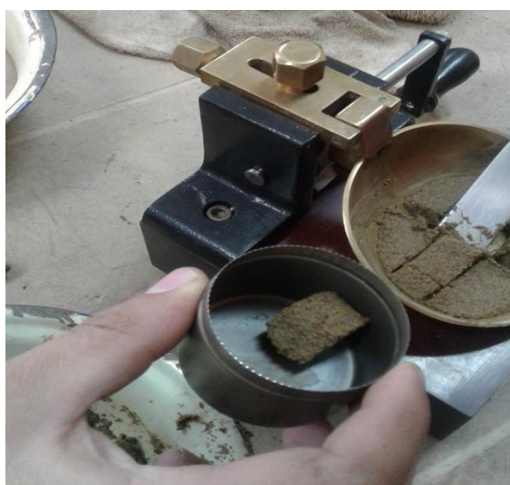
Fotografía 36: Extracción de muestra de material en una cápsula (tara)
