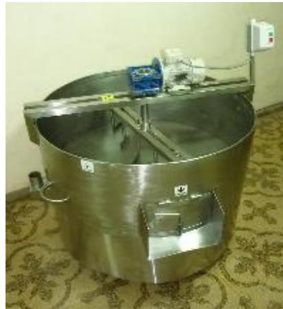
8. **Filtración:** Aquí el líquido resultante (mosto) se deberá separar del sólido realizando una primera filtración para recuperar el mosto (bebida nutritiva y proteínica) de los granos residuales, mediante tres mallas internas de acero inoxidable, durante 30 min. Una vez terminada la
