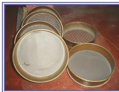
Figura 2.3. Tamices utilizados para la granulometría.
