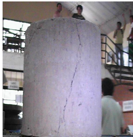
Rotura de la muestra
