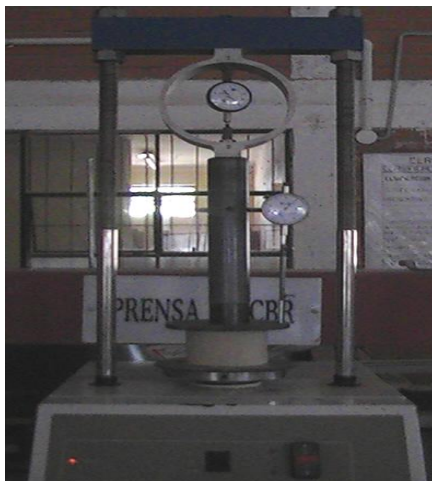
Bloque sometido a compresión por el gato hidráulico
