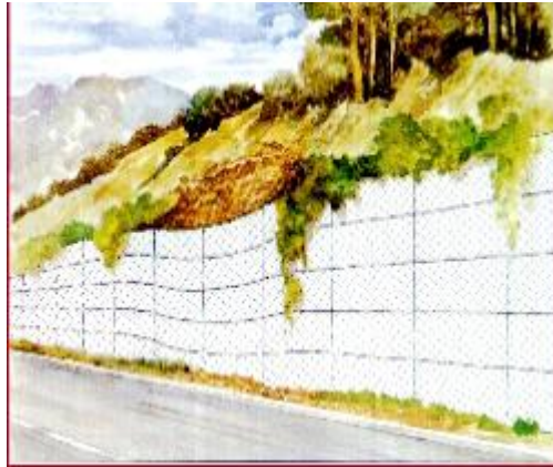
Flexibilidad del Sistema Terramesh
