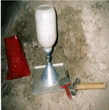
Ensayo de la Densidad in situ
