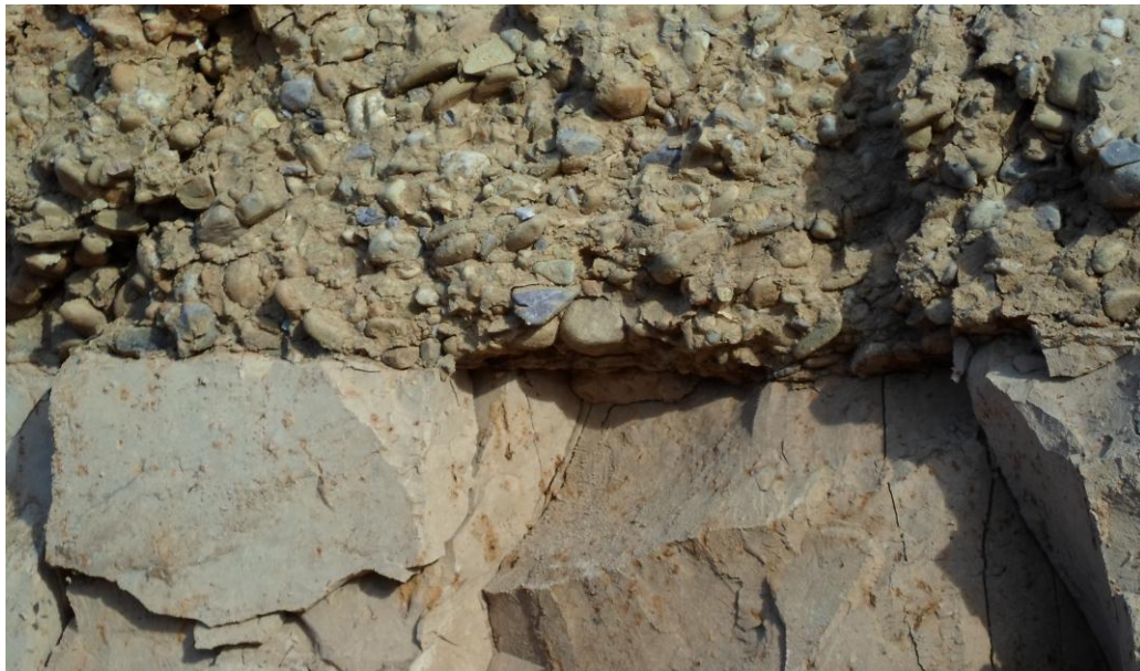
Fotografía 5.2 Conglomerado (gravas) en la formación del Talud.
