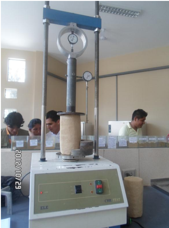
Fotografía 5.9 Prueba de compresión simple en progreso.
