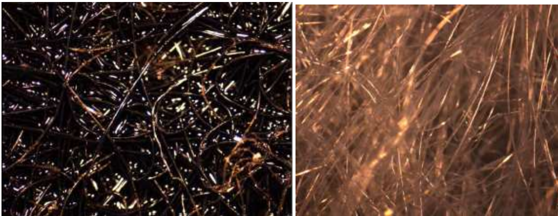
Figura 2.19 (GEOTEXTIL ANTES Y DESPUÉS DEL ENSAYO DE ADHERENCIA CON ASFALTO)
