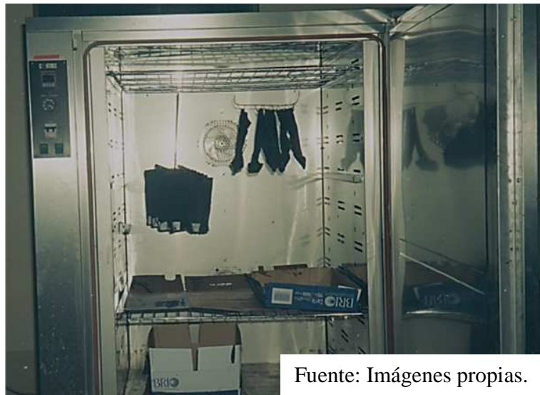
Figura 4.16 (SECADO DE GEOTEXILES EMBEBIDOS EN ASFALTO DENTRO DEL HORNO)
