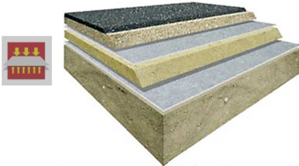
Figura 2.14 (GEOSINTÉTICO COMO SEPARADOR ENTRE CAPAS)
