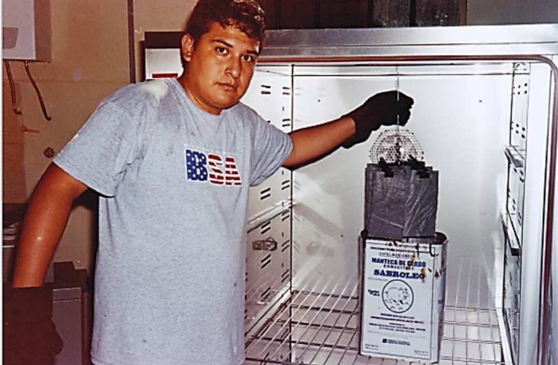
Figura 4.14 (A PUNTO DE SUMERGIR EL INSTRUMENTO CON MUESTRAS DE GEOTEXTILES EN ASFALTO DENTRO DEL HORNO)
