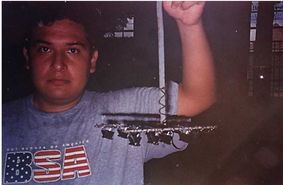
Figura 4.12 (INSTRUMENTO DE SUJECIÓN PARA LAS MUESTRAS DE GEOTEXTIL FABRICADO POR EL UNIVERSITARIO)
