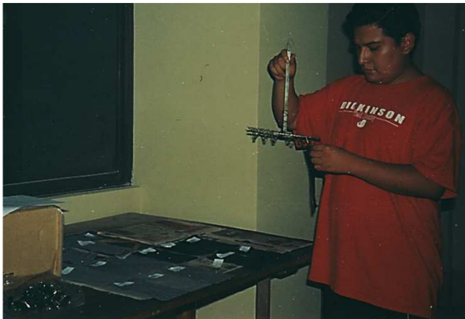
Figura 4.13 (SUJECIÓN DE LAS MUESTRAS DE GEOTEXTILES EN EL INSTRUMENTO PARA EL DESARROLLO DE LA PRÁCTICA)
