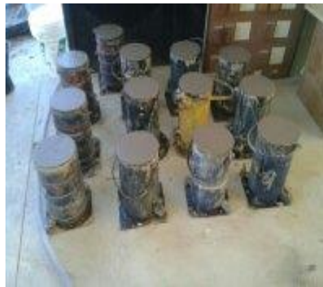
Figura 5.5.1 Probetas de prueba vaciadas, compactadas y acabadas.
