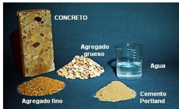
Figura 1.4.1. Materiales componentes del Hormigón
