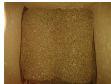
Figura 5.6.1.2 Curado con arena
