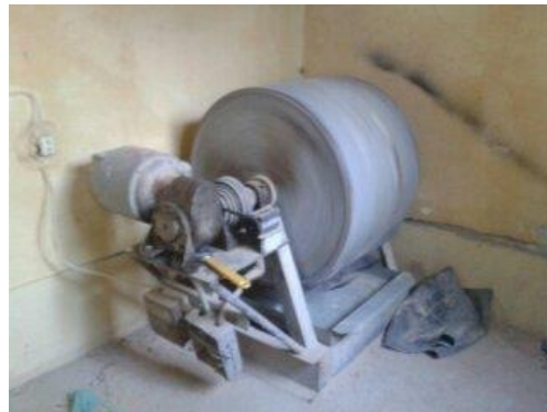
Figura 5.3.4. Maquina de Desgaste de Los Angeles (Laboratorio del SEDECA)
