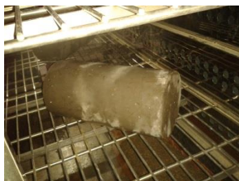
Figura 5.6.2.1 Curado en el Horno
