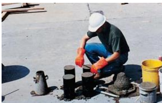
Figura 2.6.4. Especímenes de Prueba en el Campo
