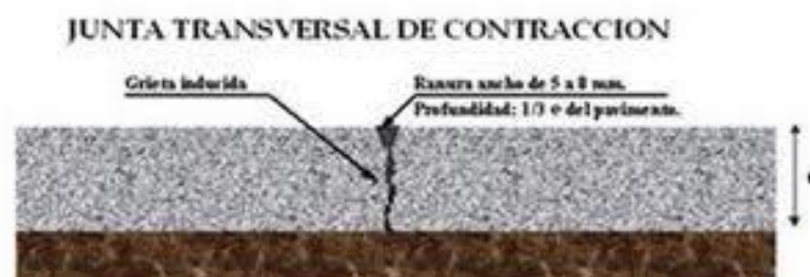
Figura 2.5.5. Juntas Transversales de contracción
