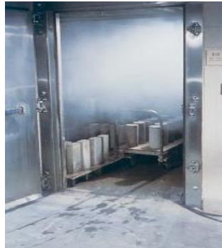
Figura 4.2.3.2. Curado acelerado con vapor
