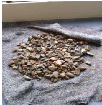
Figura 5.3.2.1. Peso Especifico del A-Grueso Figura 5.3.2.2. Peso Especifico A-Fino
