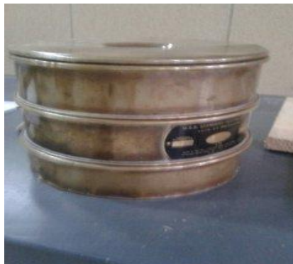
Figura 5.3.5. Tamices N 40 – N 200 utilizados en el Ensayo Finura del Cemento
