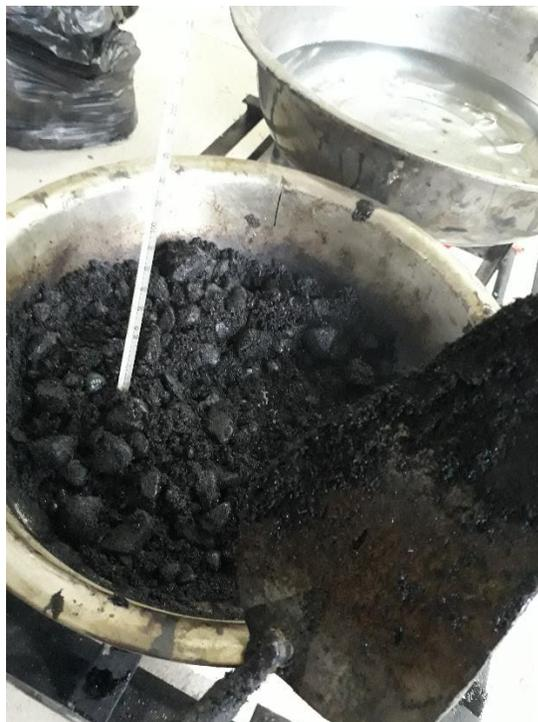
La compactación de las briquetas se realizó empleando la máquina y el procedimiento de compactación descrito en la norma AASHTO T-245, sin embargo, el número de golpes fue establecido en base a la norma INV E-760 “CARACTERIZACIÓN DE LAS MEZCLAS BITUMINOSAS ABIERTAS POR MEDIO DEL ENSAYO CÁNTABRO DE PERDIDA POR DESGASTE” de la normativa INVIAS.
