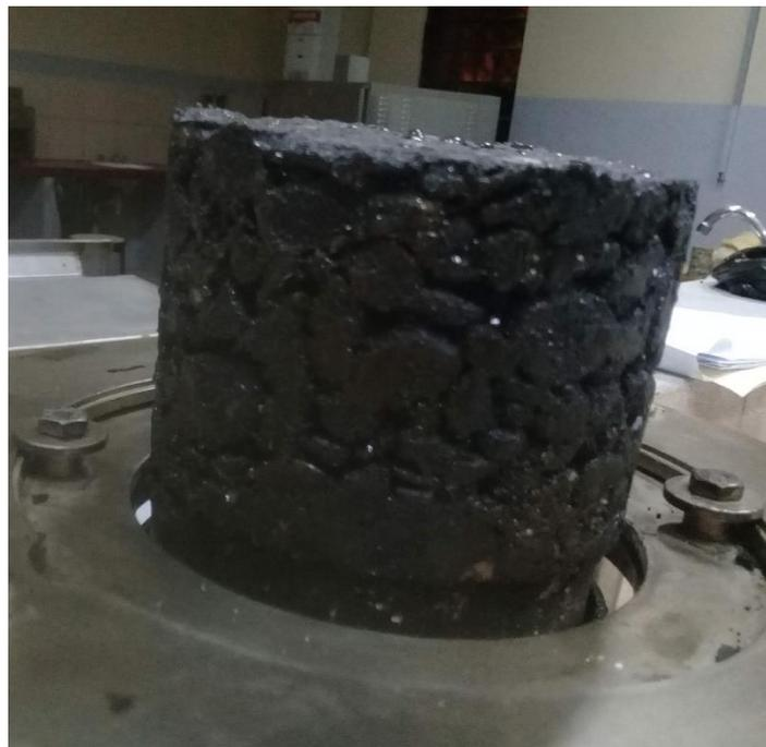
Se procedió en primer lugar a preparar los materiales con la dosificación de diseño. En un recipiente tarado se fueron pesando sucesivamente las cantidades de las fracciones de tal modo que la cantidad total de árido para cada briqueta fuera de 1000 g.
