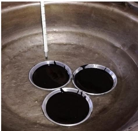
**Figura 3.15 Ensayo de penetración**
