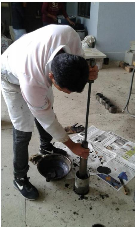
**Figura 4.3 Briquetas con mezcla porosa**
