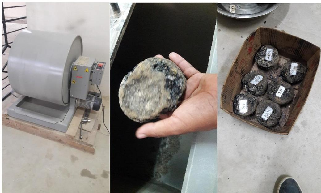
Al final del ensayo, se sacó la probeta y se determinó de nuevo su masa con la misma aproximación de 0.1 g.
