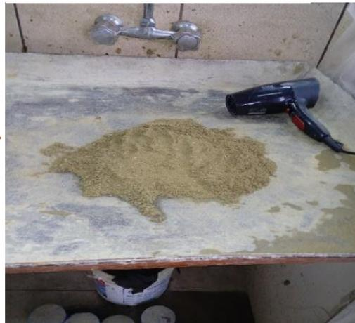
**Figura 3.8 Verificación de la condición de la muestra saturada con superficie seca**
