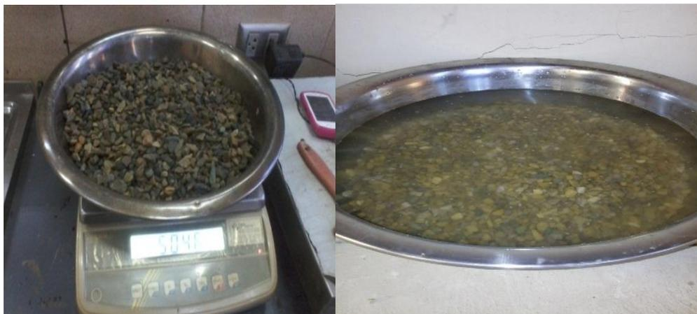
**Figura 3.4 Muestra saturada dentro del agua y uso del cesto**
