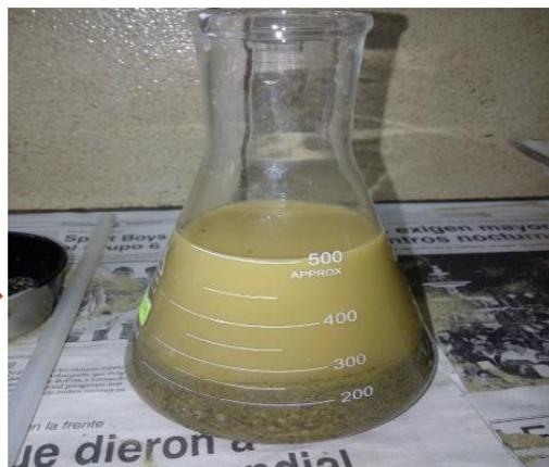
**Figura 3.10 Contenido del matraz que será secada en el horno**
