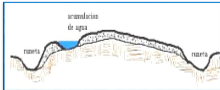
Figura N°5: Sección transversal impropia
