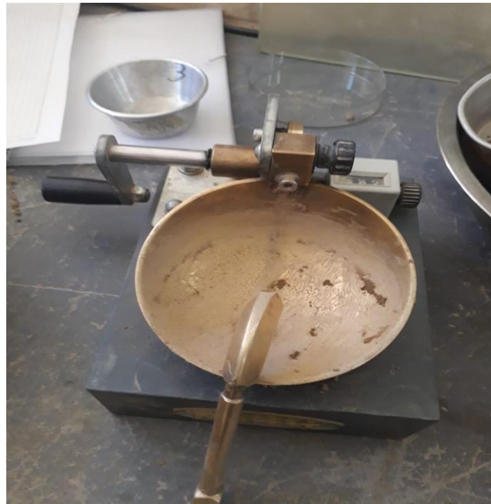
Imagen 7: Ensayo de límite líquido
