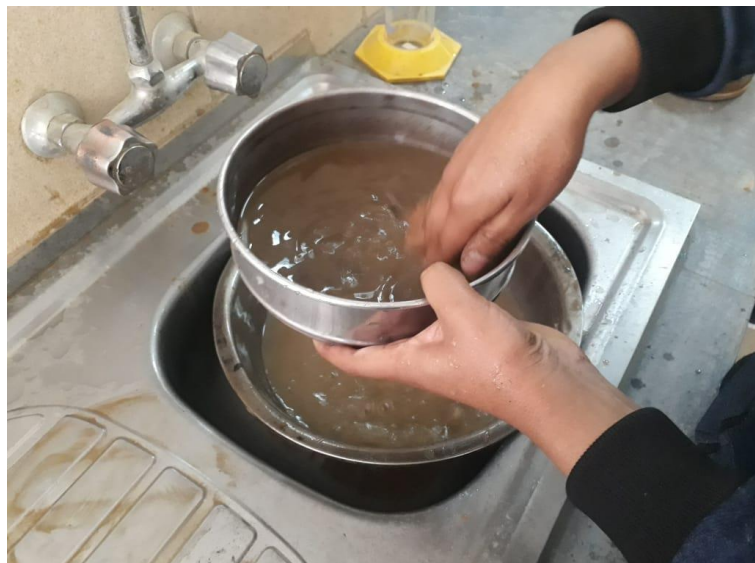
Imagen 6: Ensayo de granulometría
