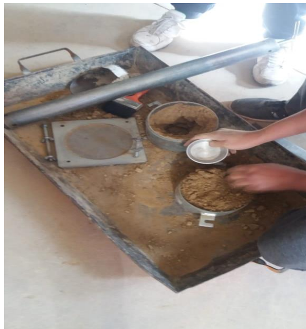
Imagen 8: Ensayo de compactación
