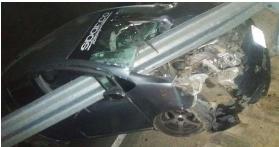
Figura Nro. 47 Riesgo de terminal de barrera
