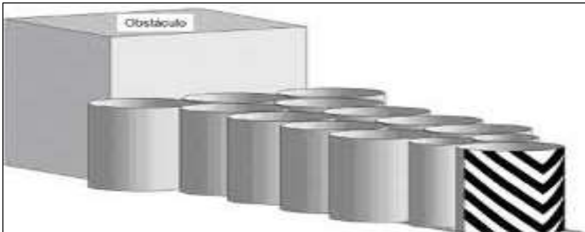
Figura Nro. 16 Amortiguador de impacto de tambores con arena
