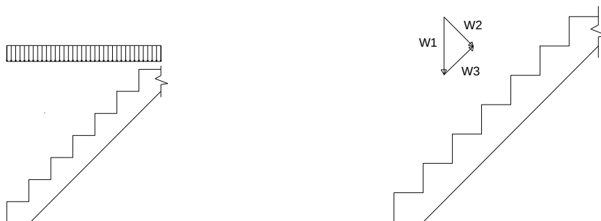
Figura 3.16.: Acción de las cargas sobre las escaleras.
