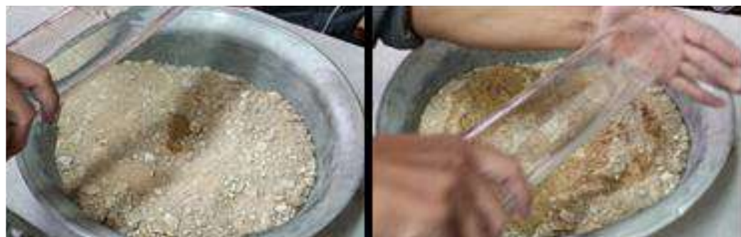
Figura 2.8 Ingreso de agua para buscar humedad específica
