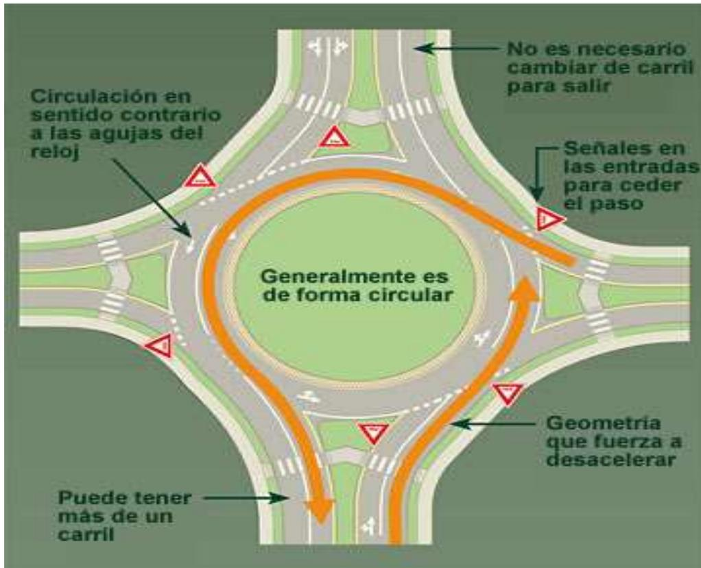
Fig. 3.1.1. Geometría de una rotonda
