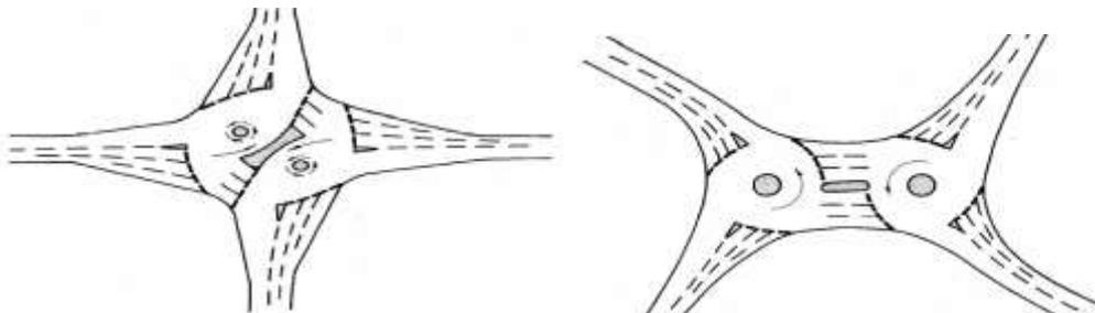
Fig. 3.3.1a. Dos ejemplos de rotondas dobles.
