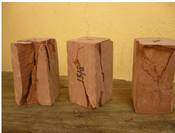
Fig. 4.26 Probetas después del ensayo.
