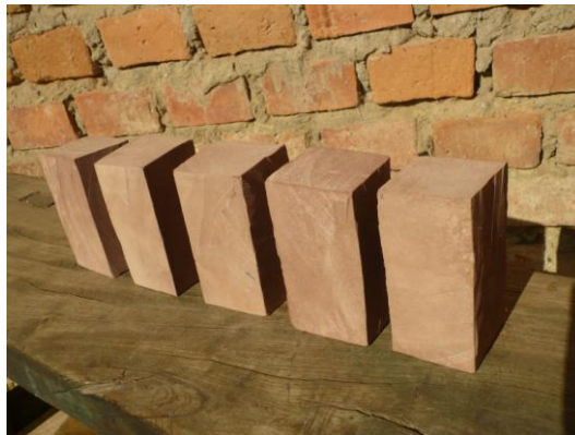
Fig. 4.22 Elaboración de las probetas, para el laboratorio.
