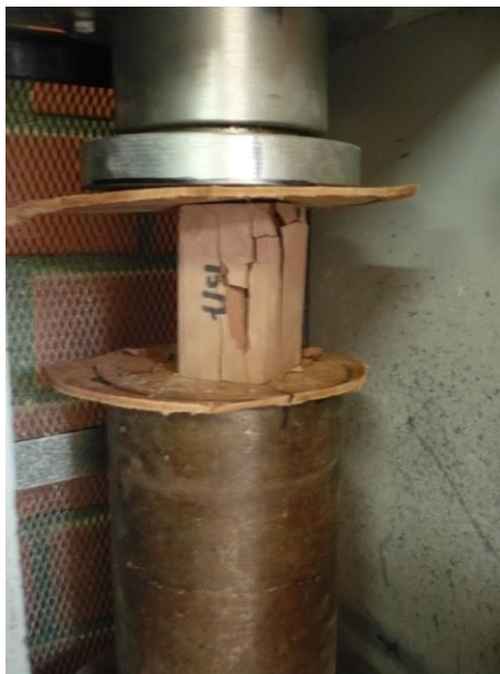
Fig. 4.23 Rotura de probeta N°1.
