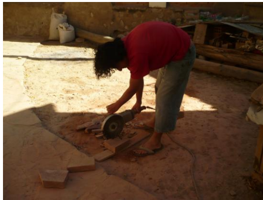
Fig. 4.21 Elaboración de las probetas.
