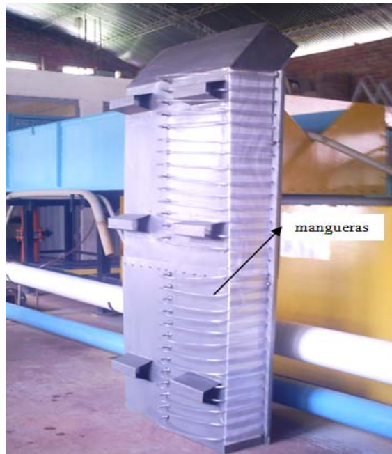
Foto 24: Mangueras colocadas para medir la presión manométrica en cada punto de la línea central del Tanque TIPO I.
