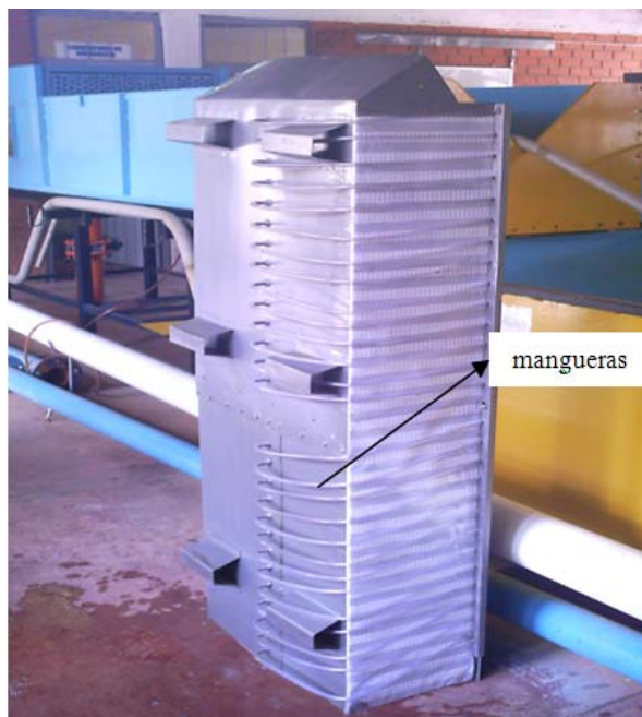
Foto 25: Mangueras colocadas para medir la presión manométrica en cada punto de la línea central del Tanque TIPO III.
