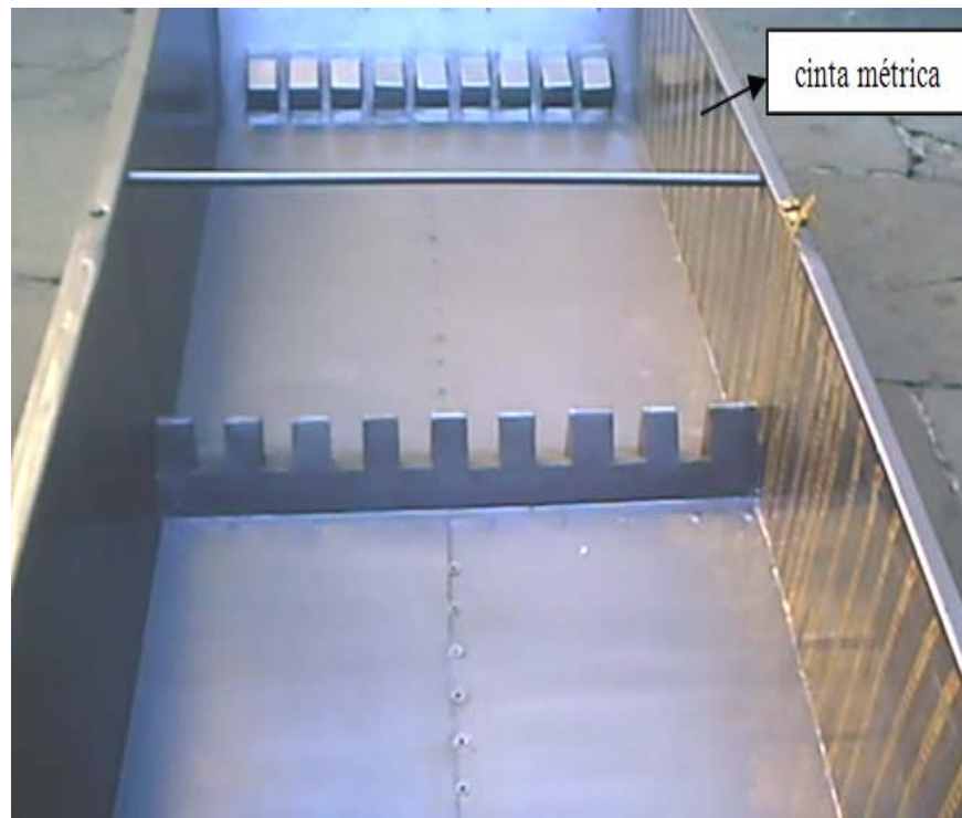
Foto 22: Cinta métrica colocada en el Tanque TIPO III.
