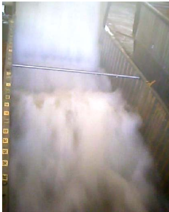
Foto 14: Modelo Físico Reducido Tanque TIPO III, Instalación en el Laboratorio puesto en funcionamiento. Escala 1:15.
