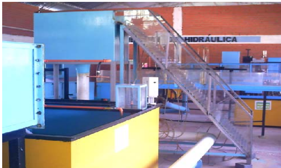
Foto 11: Modelo del Aliviadero finalmente instalado en el Laboratorio de Hidráulica.
