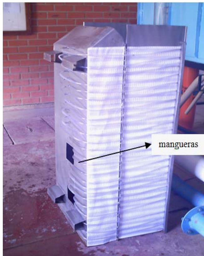
Foto 23: Mangueras colocadas para medir la presión manométrica en cada punto de la línea central del Pozo Amortiguador.
