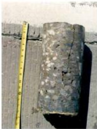
Figura 28 Tipos de agrietamiento por fatiga considerados en pavimentos rígidos
