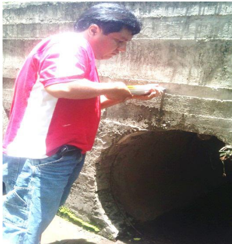
Figura 43. Uso del esclerómetro con ángulo de 0 grados
