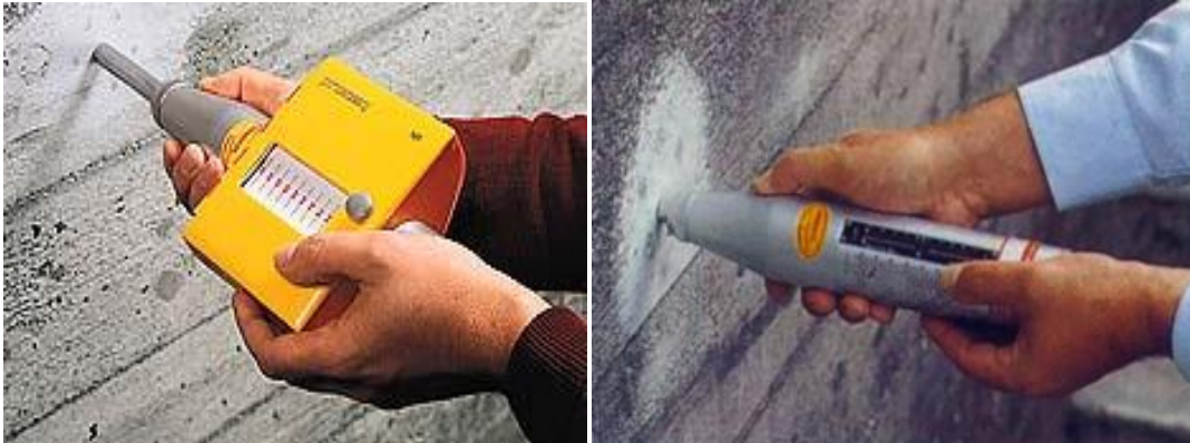
Figura 39. Medidor de dureza de hormigón
