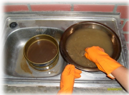
Figura 3.2. Método de Lavado (agregado fino).
