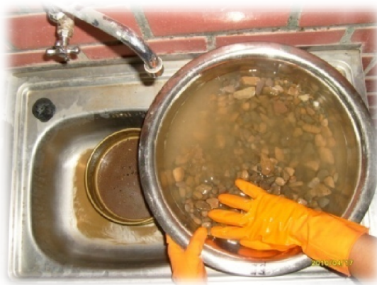
Figura 3.9. Método de Lavado (agregado grueso).
