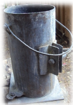
Figura 4.8. Molde para Probeta Cilíndrica
