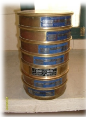
Figura 3.10. Serie de Tamices (agregado grueso).
