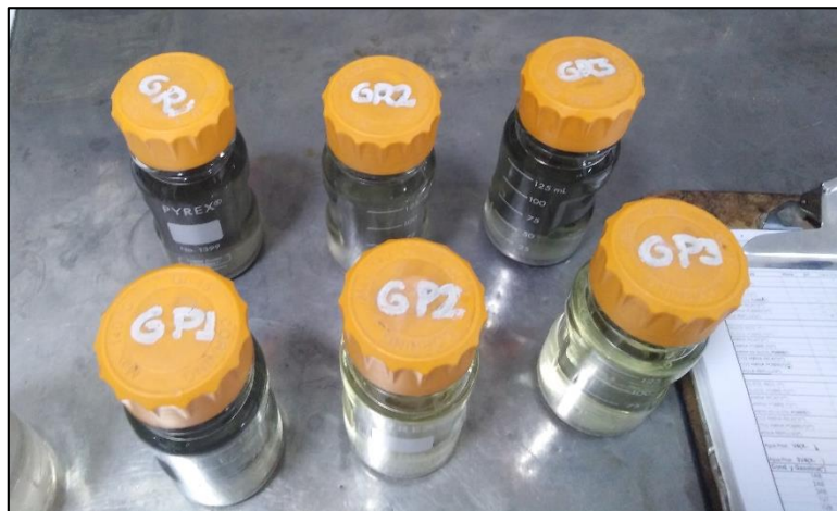
Fig. 3- 1 Muestras de Glicol Rico y Glicol Pobre de los 3 Trenes de Tratamiento de Gas de la Planta Sábalo
