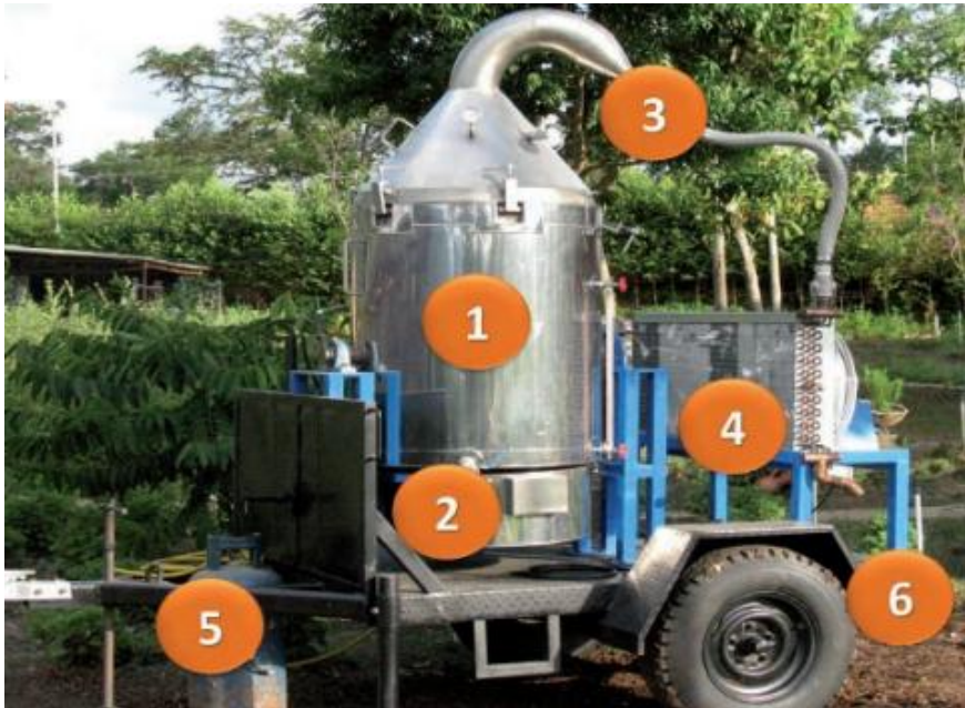
Figura 2-4: Destilador de aceites esenciales móvil de material vegetal
