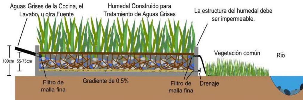
**Figura 2-6.** Sistema Subterráneo Típico de Humedales Construidos. (Salas, 2013)
