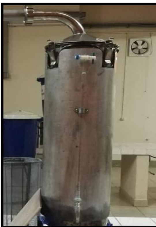
Foto 2- 13: Cámara de extracción
