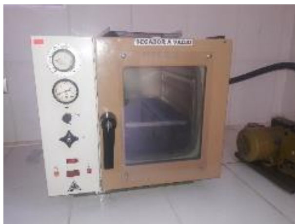
Figura 3- 13 Equipo utilizado para secar el colorante
