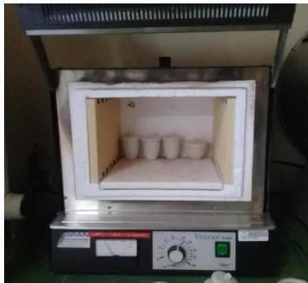
Fig. 3- 9 Incineración de la cascarilla de arroz
