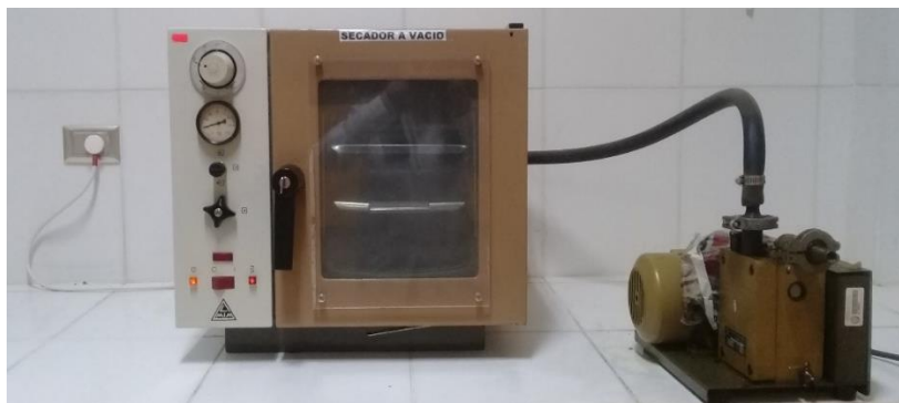
Fig. 3- 11 Secado de la vinaza concentrada y el aditivo homogenizado
