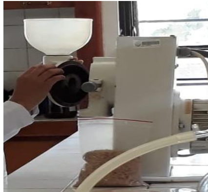
Fig. 3- 8 Molienda de la cascarilla de arroz
