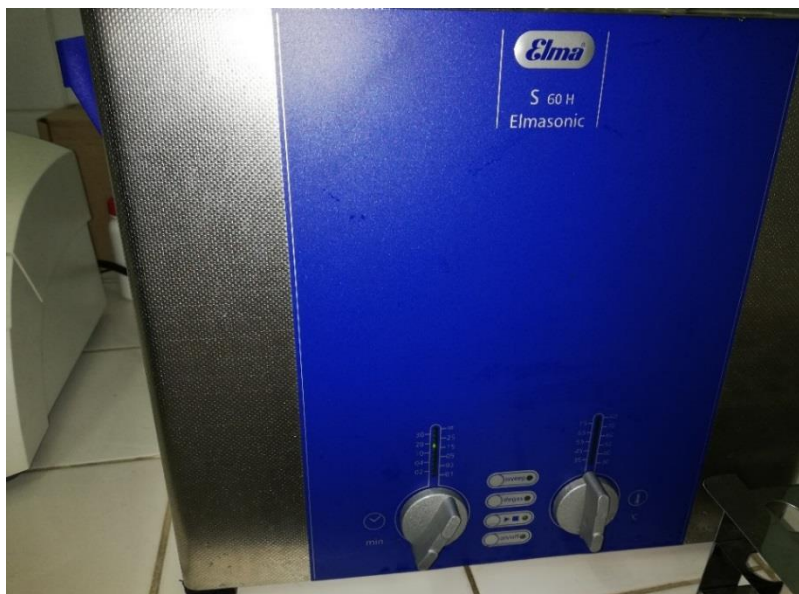
Imagen IV-22 Sonicador (Extracción de muestras)
