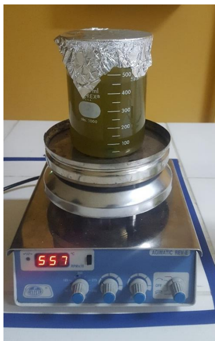
Figura 4-21 Extracción de la resina
