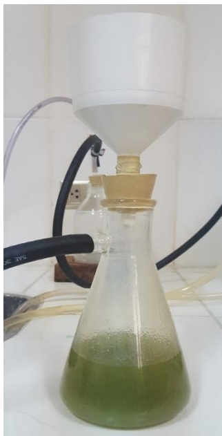
Figura 4 -22 Filtración de la solución cera – solvente
