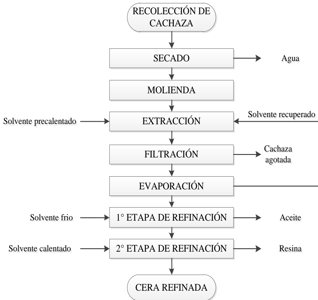
Figura 4-3 Diagrama de bloques del proceso de extracción de cera refinada de caña de azúcar a partir de cachaza
