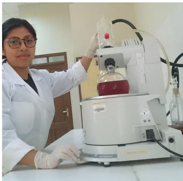
Fotografía 3- 12 Rota-evaporador con la muestra en el matraz
