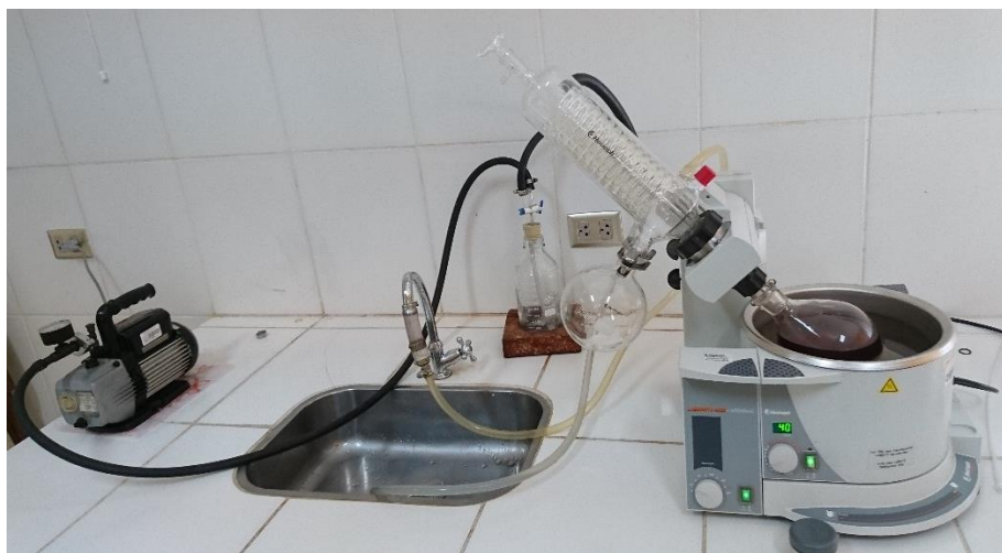
Fotografía 3- 13 Conexión del Rota-evaporador para la concentración del extracto
