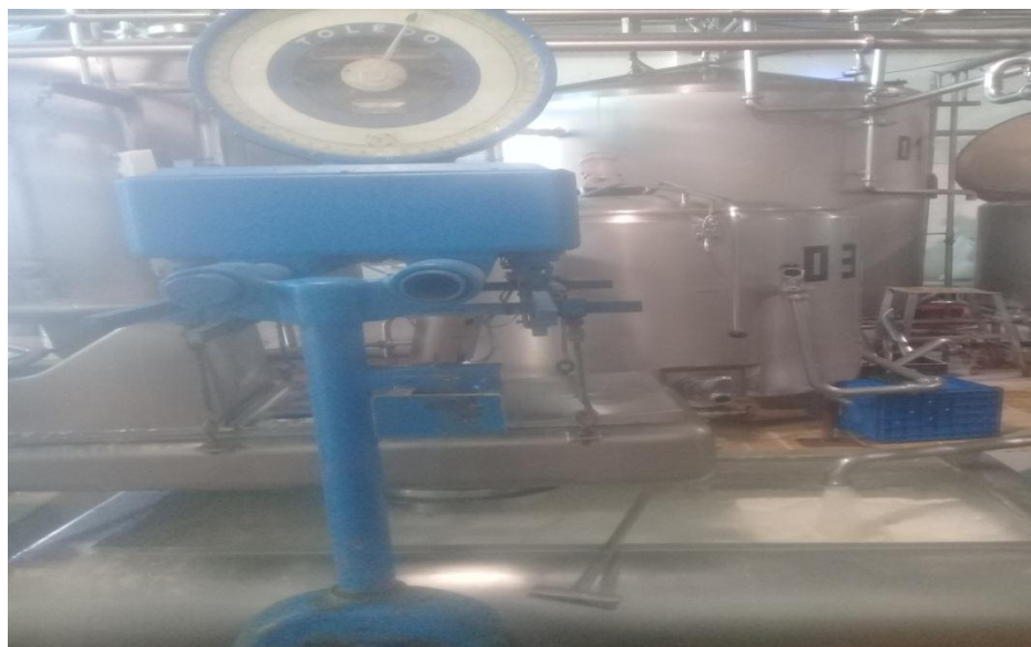
Figura 4-2: Balanza de pesado y tina de recepción de la leche fresca en PIL Tarija S.A.
