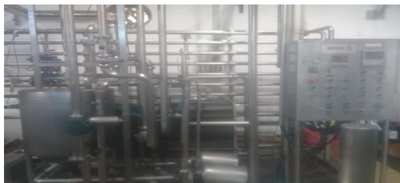
Figura 3-20: Pasteurizador por Placas de PIL Tarija S.A.
