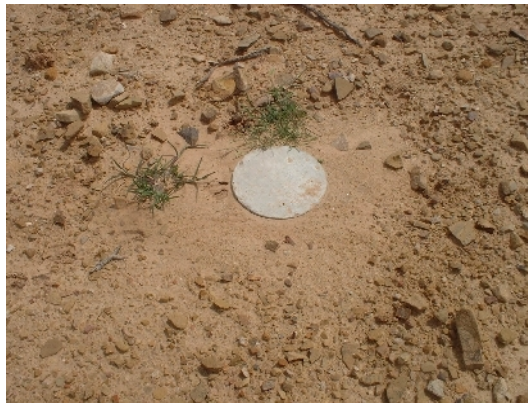
Probeta de hormigón colocada aproximadamente a 1000 m una de otra.
