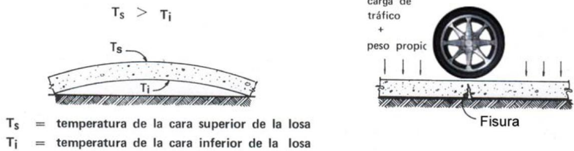
Figura 2.9 Deformación de la losa durante el día, origen de la grieta por carga
