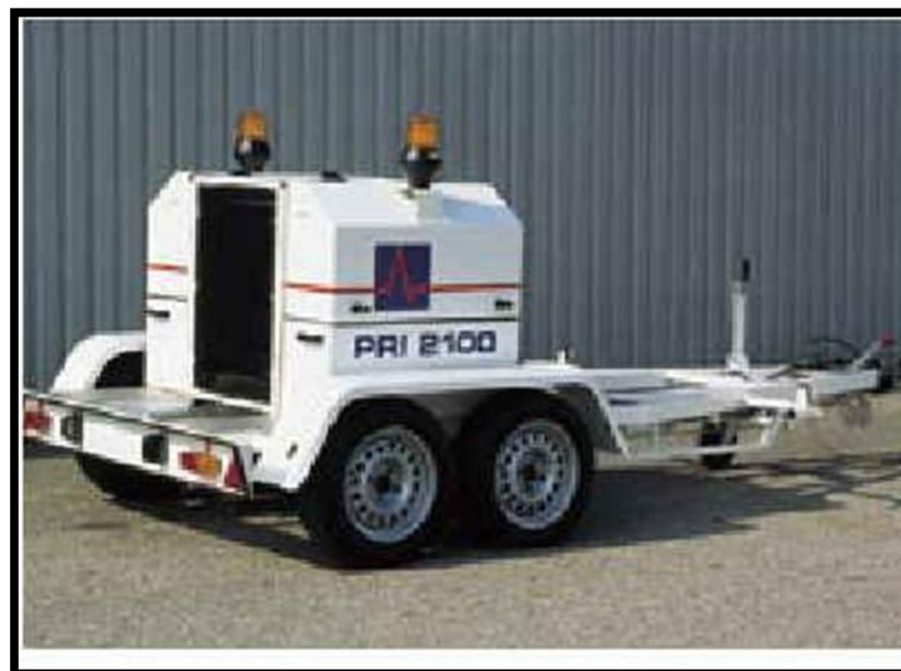
Imagen 5-4 Deflectómetro de impacto FWD-1 (tipo PRI2100) Fuente ABC.
