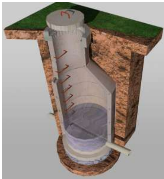
Figura 5.1 Perspectiva cámara de inspección simple
