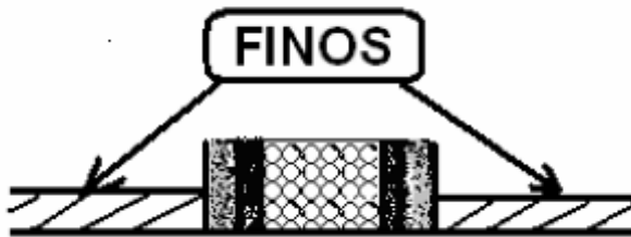
FIGURA 3. 11 CONSTRUCCIÓN DEL DREN Y LOS FILTROS CON RELACIÓN A LOS LADOS FINOS
