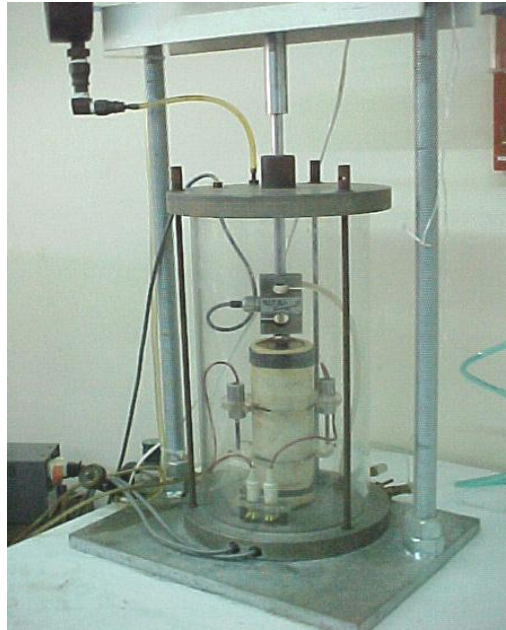
Figura.3.9 Cámara triaxial para ensayos cíclicos.
