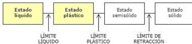
Fig. 2.2 Estados de consistencia de un suelo.
