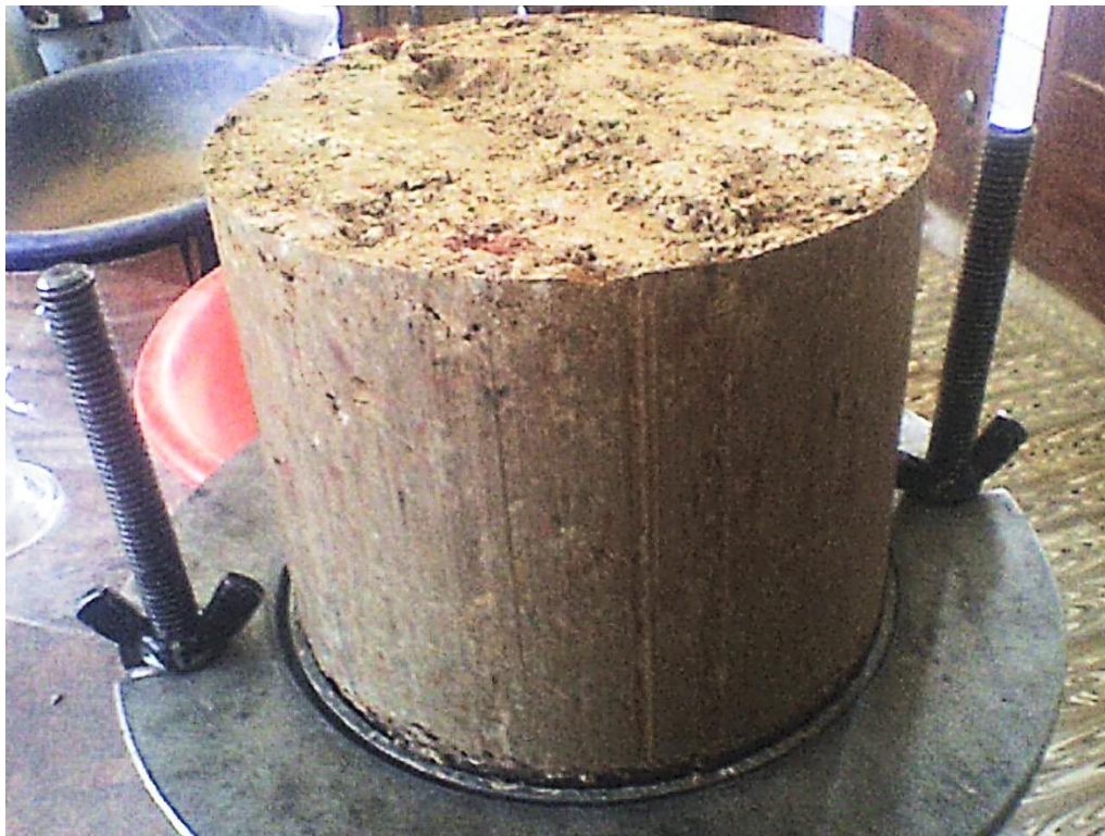
Fotografía 4M Pesado del Material + Molde y su posterior Extracción
