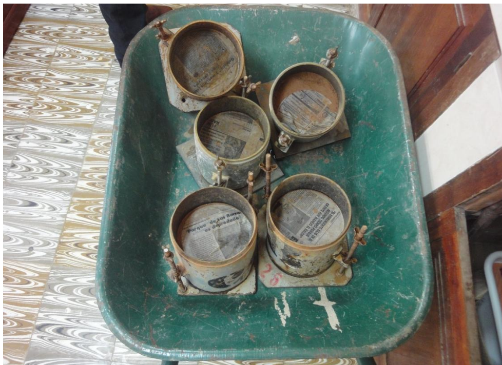
Fotografía 40 Traslado de las muestras al instrumento C.B.R.
