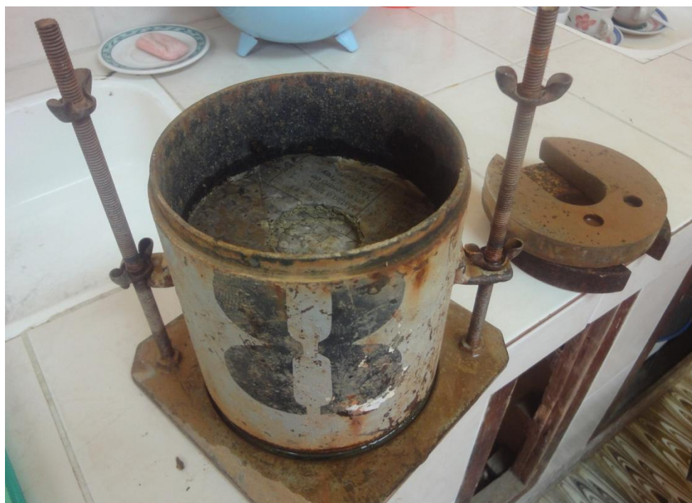
Fotografía 4T Molde después del Ensayo con la correspondiente marca de penetración del Pistón
