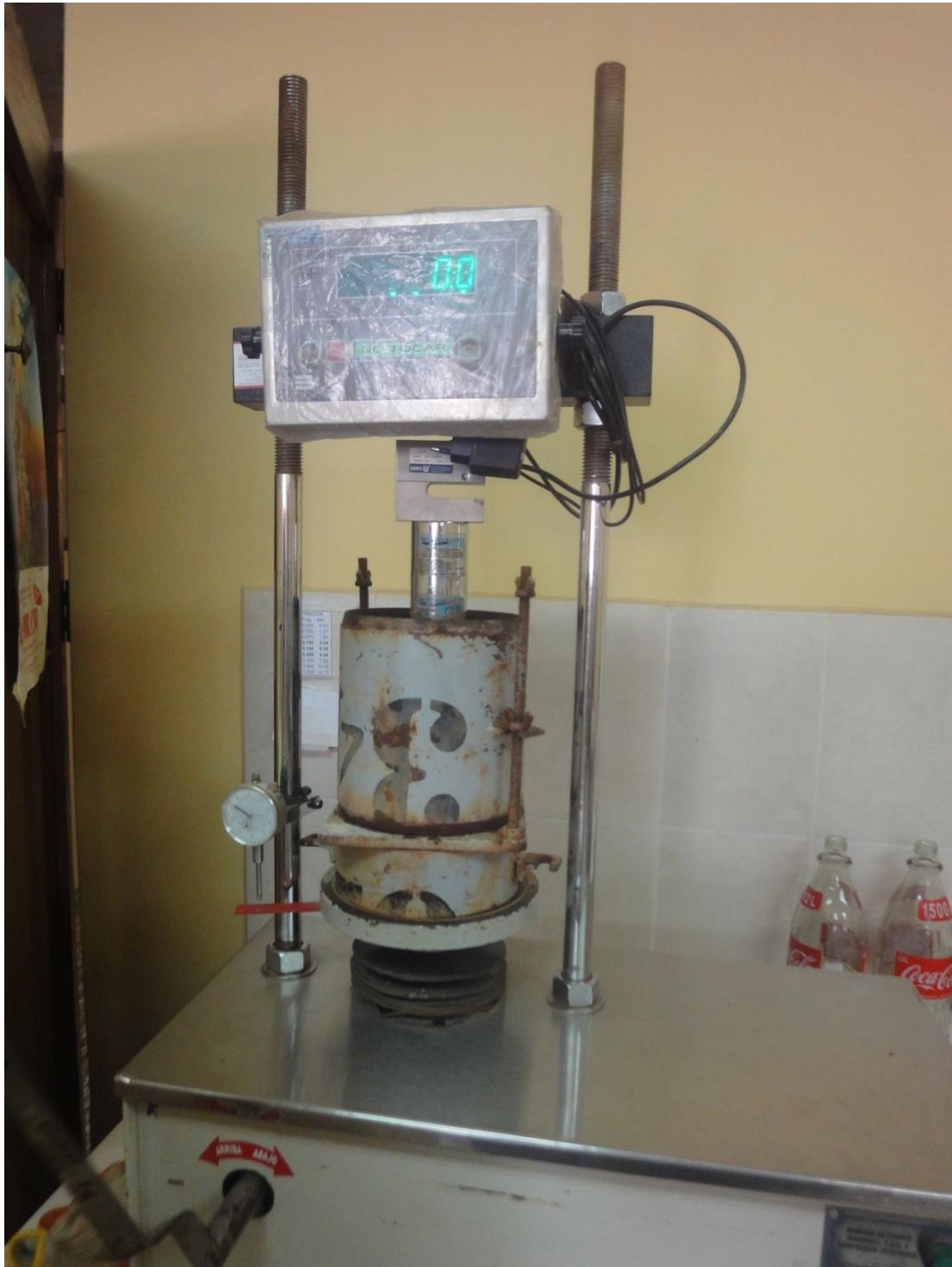
Fotografía 4Q puesta en cero del Instrumento C.B.R. antes de comenzar el ensayo
