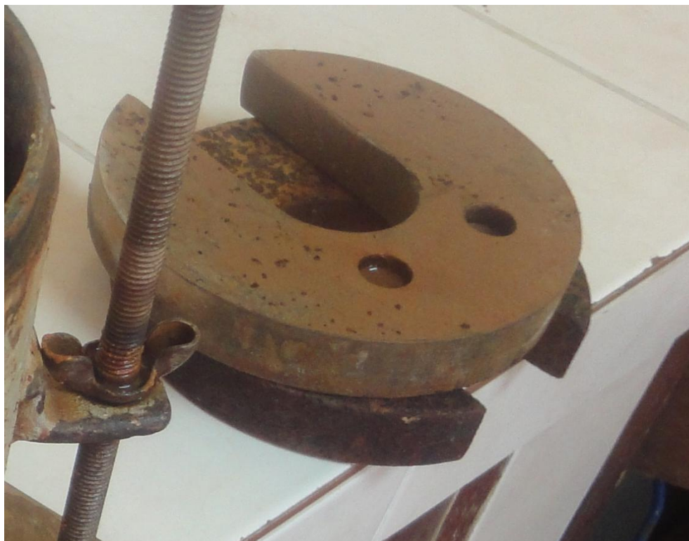
Fotografía 40A Pesas collarines para direccionar el pistón del instrumento
