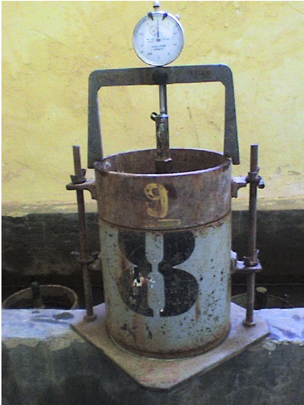
Fotografía 4N Medición de la Expansión
