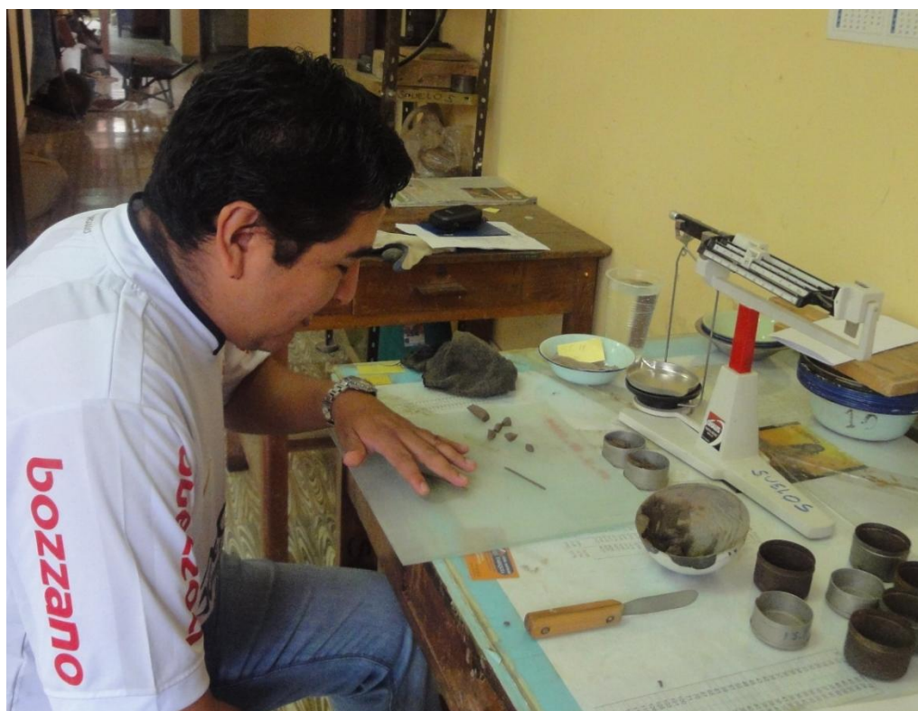
Fotografía 4F Ensayo de Límites de Atterberg.
