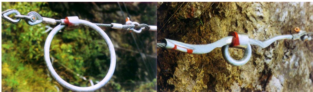
Fotografía 3F Freno de fricción Antes y después de la Absorción de Impacto
