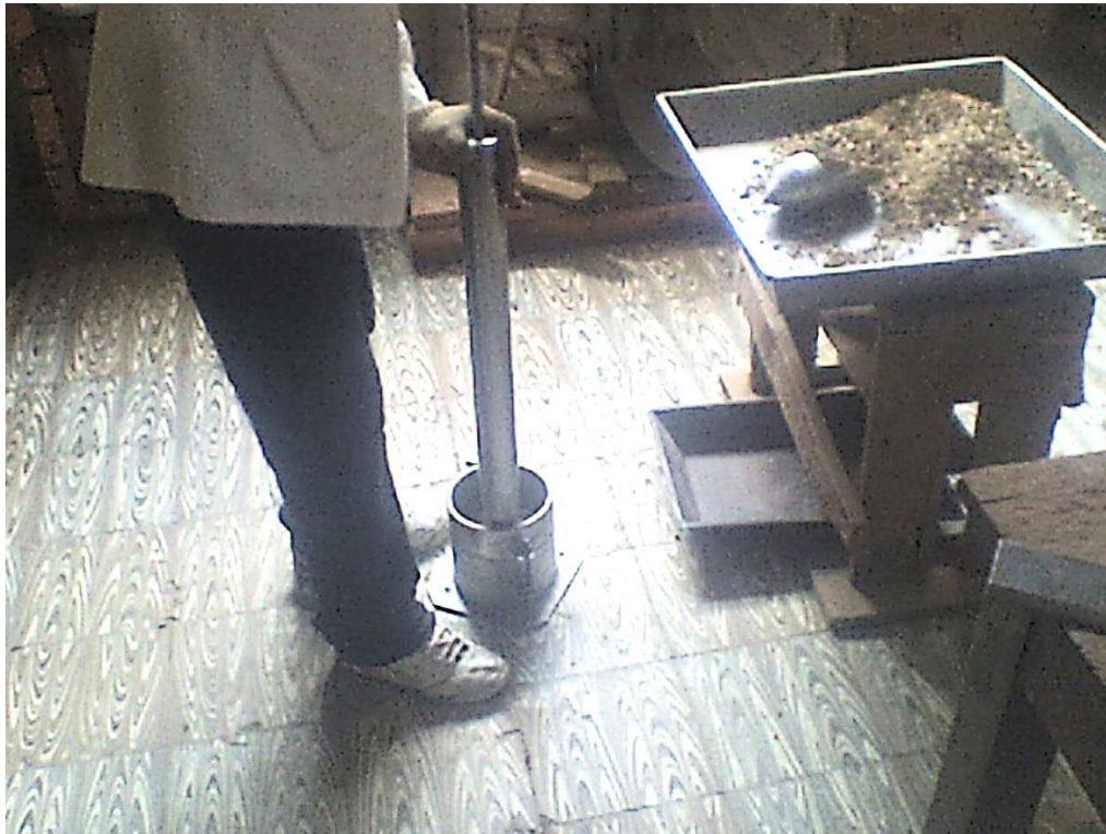
Fotografía 4L Compactación en tres capas
