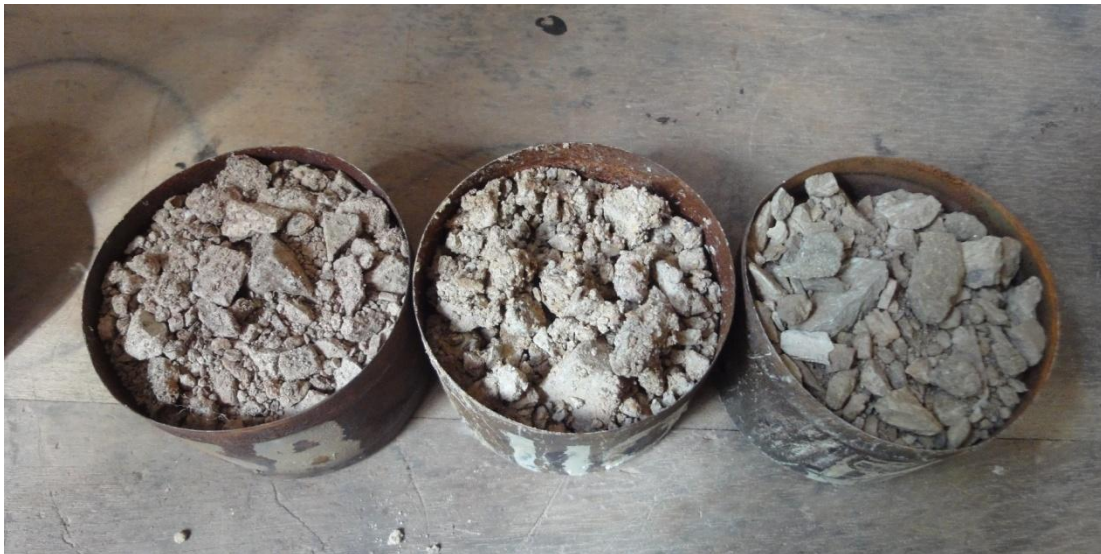
Fotografía 5G Cápsulas de muestra para obtener la humedad natural
