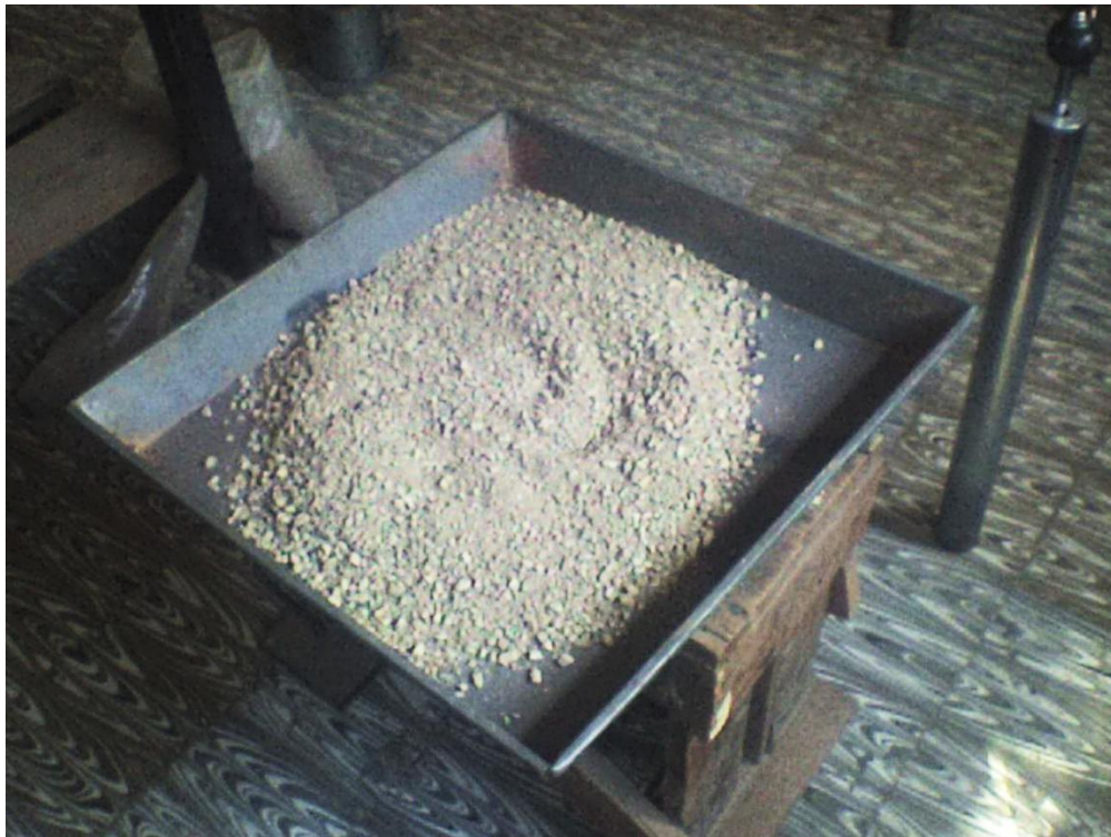
Fotografía 4K extendido de la Muestra para humedecer y homogeneizar
