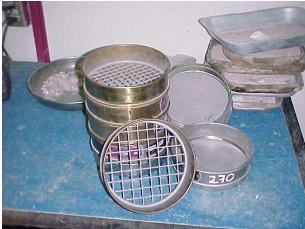
Fotografía 4H Serie de tamices necesarios para el ensayo
