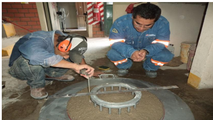
Foto 4 Ensayo de anillo J
