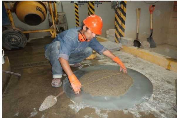
Foto 2 Prueba de extensión de flujo
