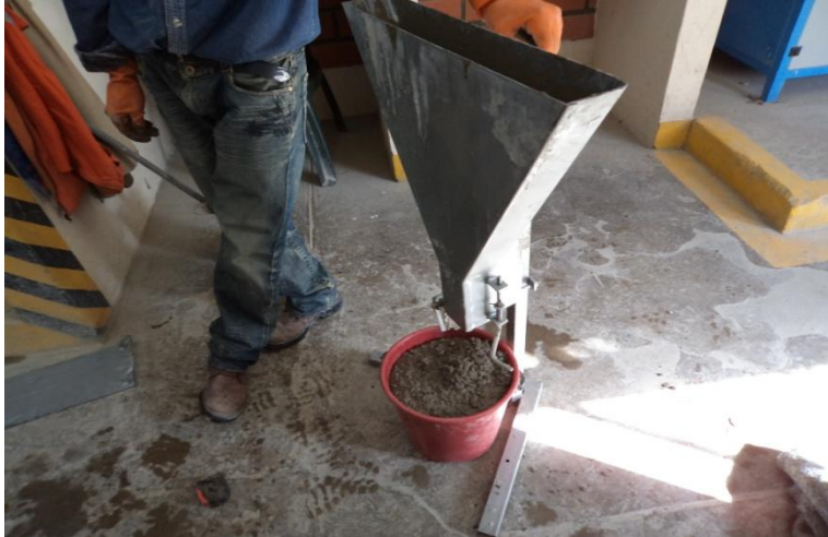
Foto 6 resultado de ensayo del embudo en V
