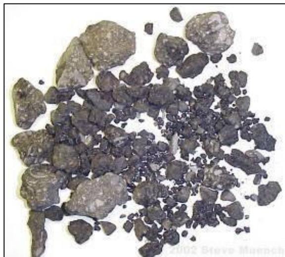
Imagen 2: Material fresado de capas de firme
