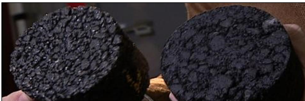
Figura 3: Diseño de briquetas según método Marshall
