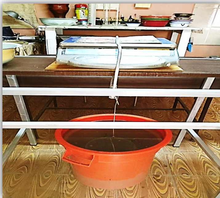
Figura 3.4. Obtención del peso sumergido.
