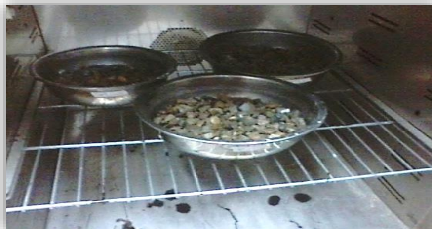
Figura 3.5: Secado de la muestra en el horno.
