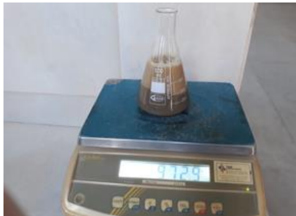
Imagen 3.14. Peso del agregado fino más el matraz y agua
