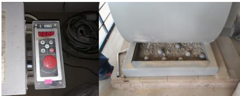
Imagen 3.16. Muestra sacada de la máquina de los ángeles a 500 revoluciones
