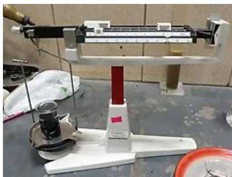
Imagen 3.22. Ensayo de peso específico de cemento asfáltico, determinación de la masa de la muestra
