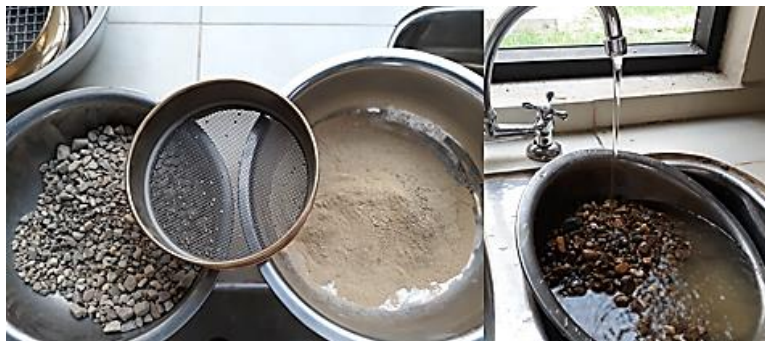
Imagen 3.17. Muestra separada por el tamiz N°12 y lavada
