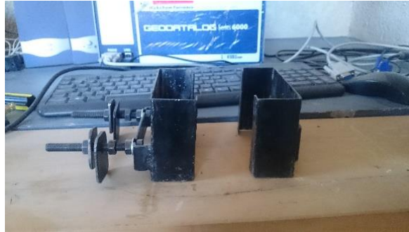
Imagen 3.44: Molde para asegurar la junta en el equipo
