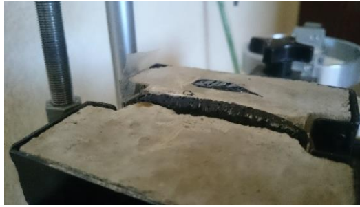
Imagen 3.47: Junta después de realizar el ensayo
