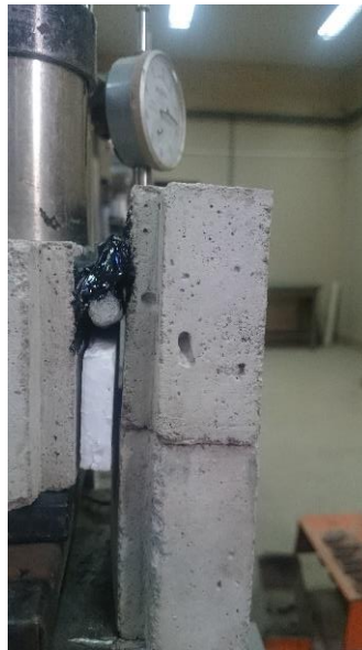
Imagen 3.53: Junta después de realizar el ensayo
