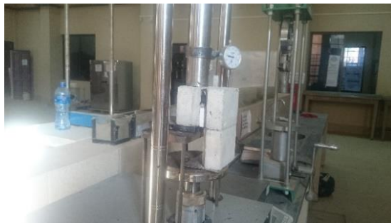
Imagen 3.51: Junta antes de realizar el ensayo de corte
