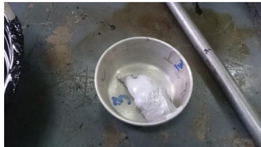
Imagen 3.22: Mezcla del cemento asfáltico reciclado añadiendo porcentajes de modificador silíceo
