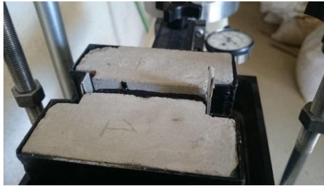
Imagen 3.45: Junta en el equipo antes de realizar el ensayo de trabajabilidad
