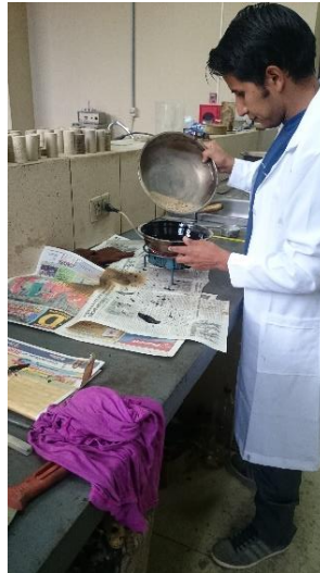
Imagen 3.41: Mezclado de sellador con agregado fino
