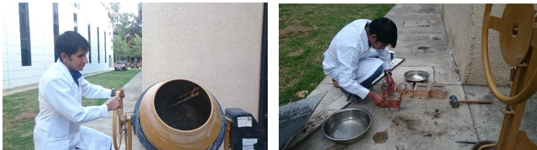
Imagen 3.26: Hormigonado en moldes
