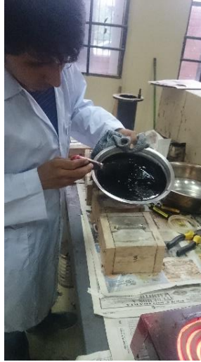
Imagen 3.42: Vaciado del sellador en la junta
