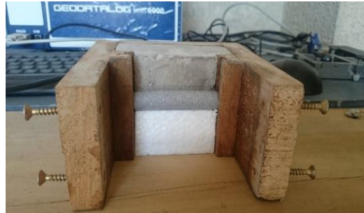
Imagen 3.28: Junta con icopor y tirilla de respaldo
