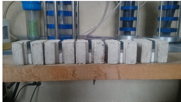
Imagen 3.43: Desmoldado de la junta con el sellador
