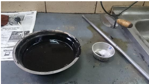
Imagen 3.22: Mezcla del cemento asfáltico reciclado añadiendo porcentajes de modificador silíceo
