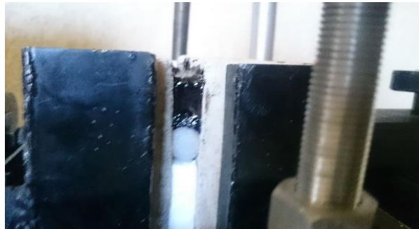
Imagen 3.48: Junta en el equipo antes de realizar el ensayo de adherencia
