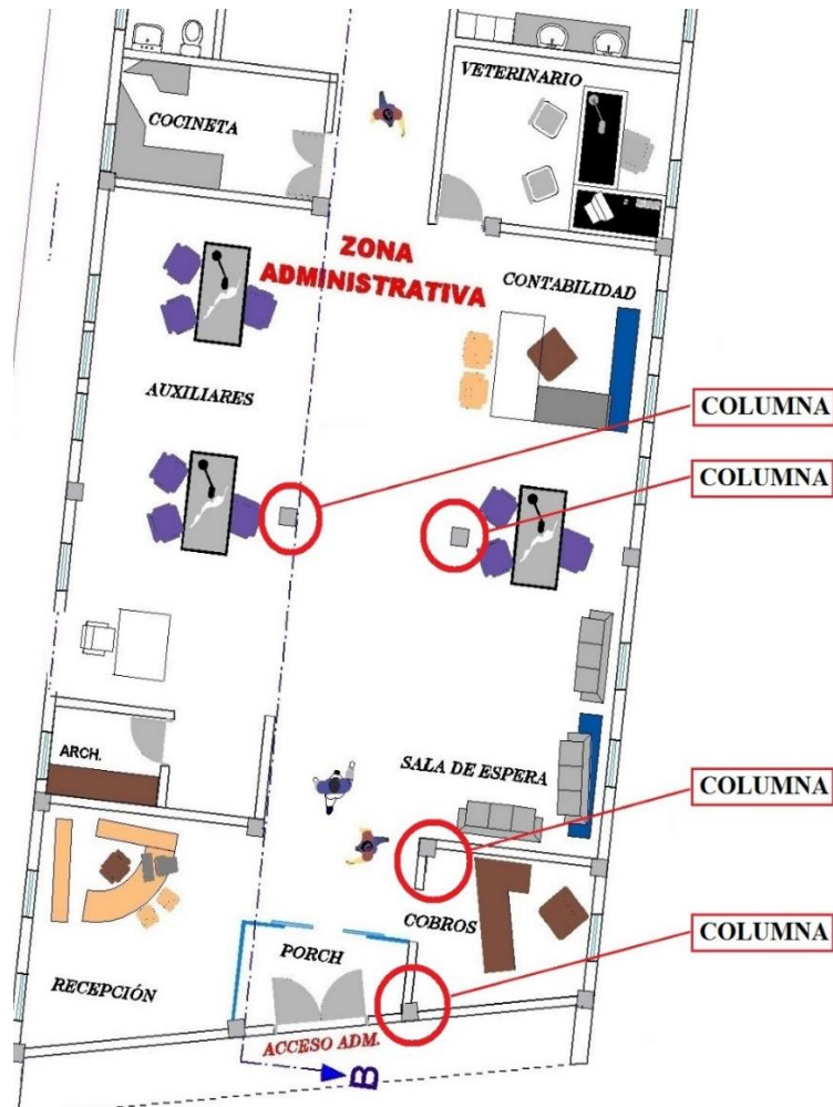
Figura 4. 1 Presencia de columnas innecesarias
