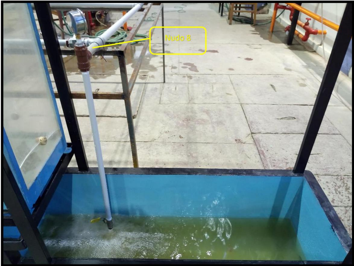
Nudo 8, salida de sistema de red cerrada, cuenta con un manómetro de glicerina para medir la presión y un tanque de aforo.
