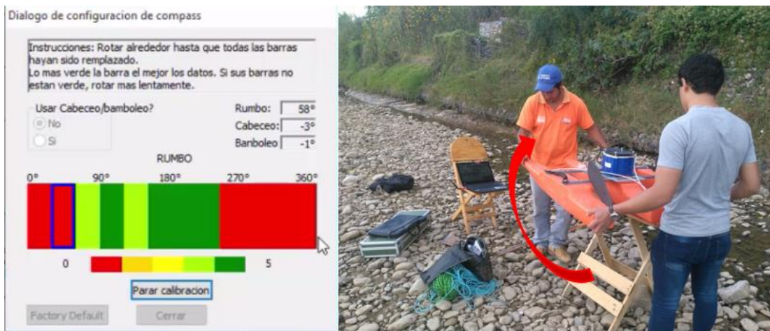
Figura N° 4. 15. Rectificación de errores al girar el ADCP
