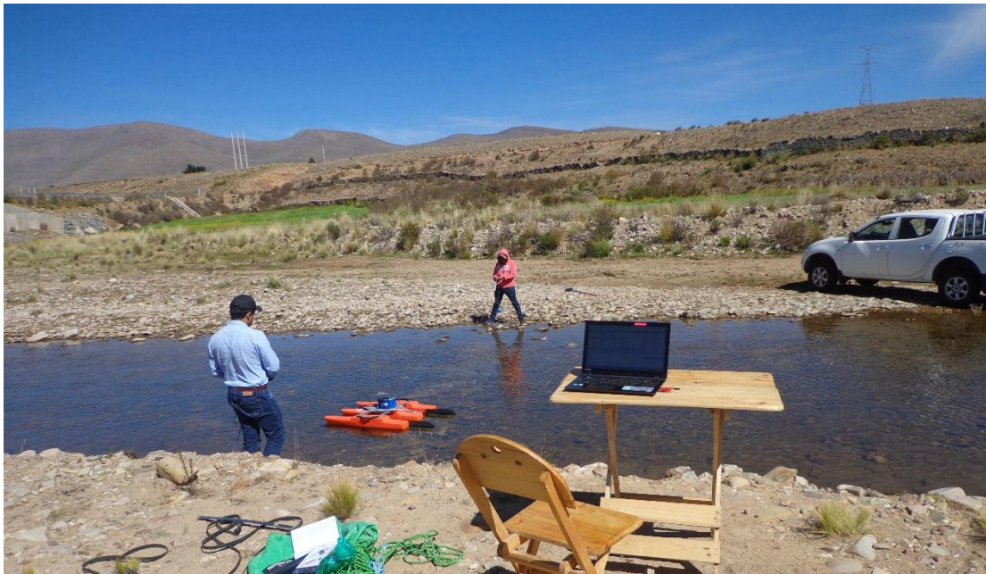
Figura N° 3. 7 Sección de aforo en el río Tomayapo aguas abajo del puente (ruta a Potosí)
