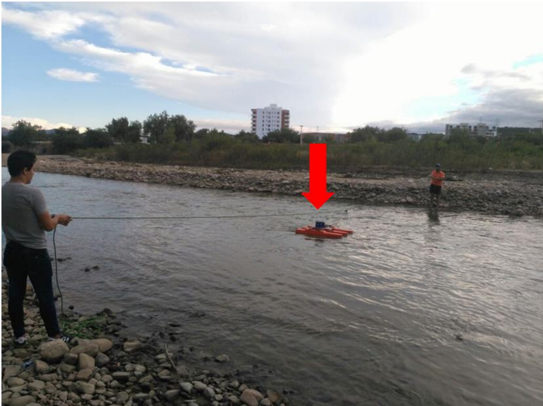
Figura N° 4. 19. Realizando la prueba de fondo móvil estacionaria
