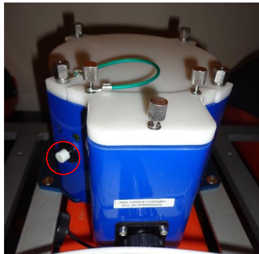
Figura N° 4. 1. Encendido del ADCP
