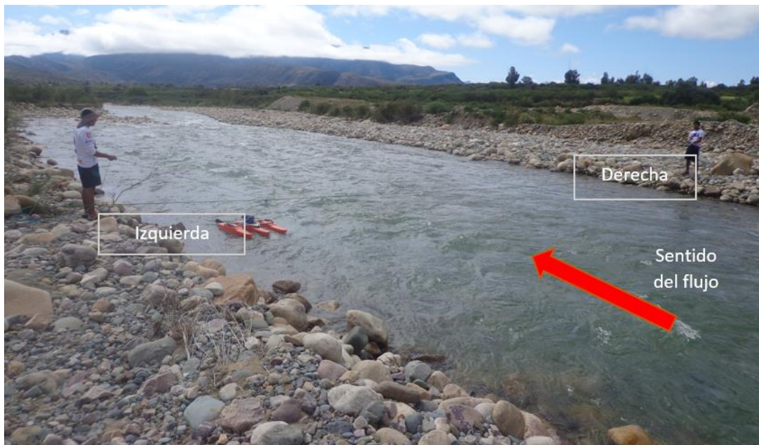
Figura N° 4. 25. Identificando la posición a la que se encuentra el ADCP
