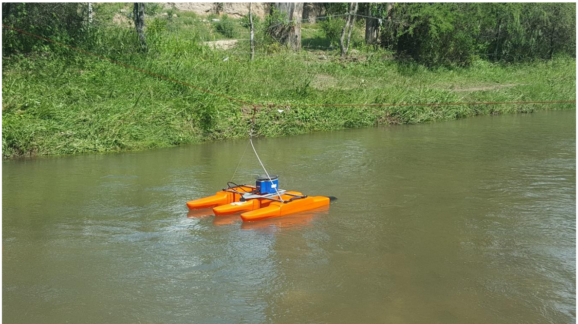
Figura N° 2. 10. Perfilador de Corrientes Acústico Doppler
